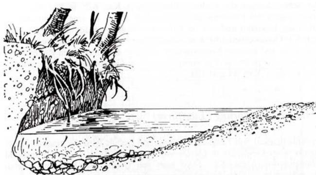
Abb. 11: Prall- und Gleitufer – die Ufervegetation am Prallufer stabilisiert die Böschungen und sorgt für eine Beschattung des Gewässers (PATT et al., 2009, S. 63)
