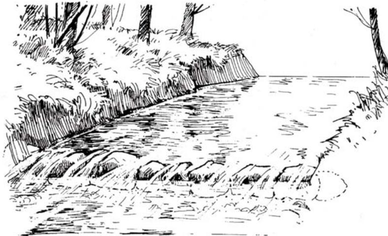
Abb. 63: Stabilisierung eines Gewässers durch eine Grundschwelle (PATT et al., 2009, S. 301)
