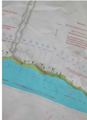
Abb. 38: Maßnahmenplan, mit ingenieurbioologischen Maßnahmen zur Uferstabilisierung, Drau – Spittaler Feld, HÖFLER, 2006
