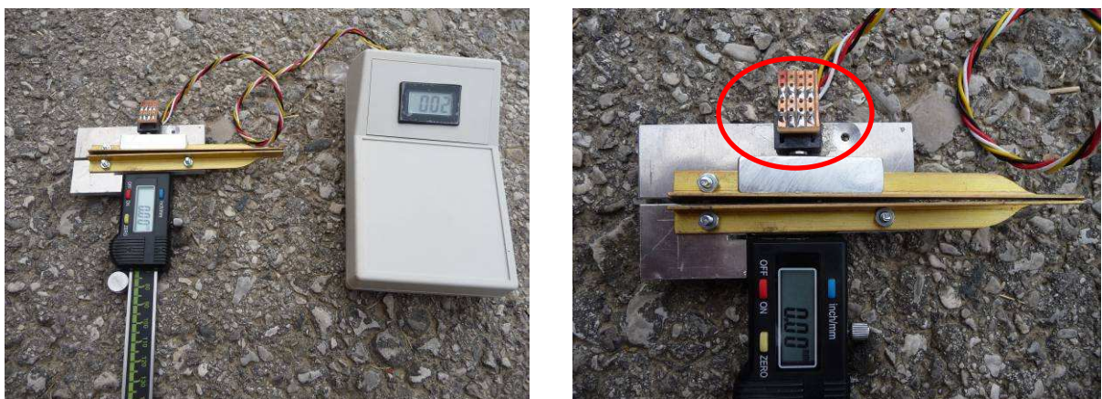
Abbildung 11: Schiebelehre mit Druckmessung (roter Kreis = Drucksensor, Fotos: Besser)
