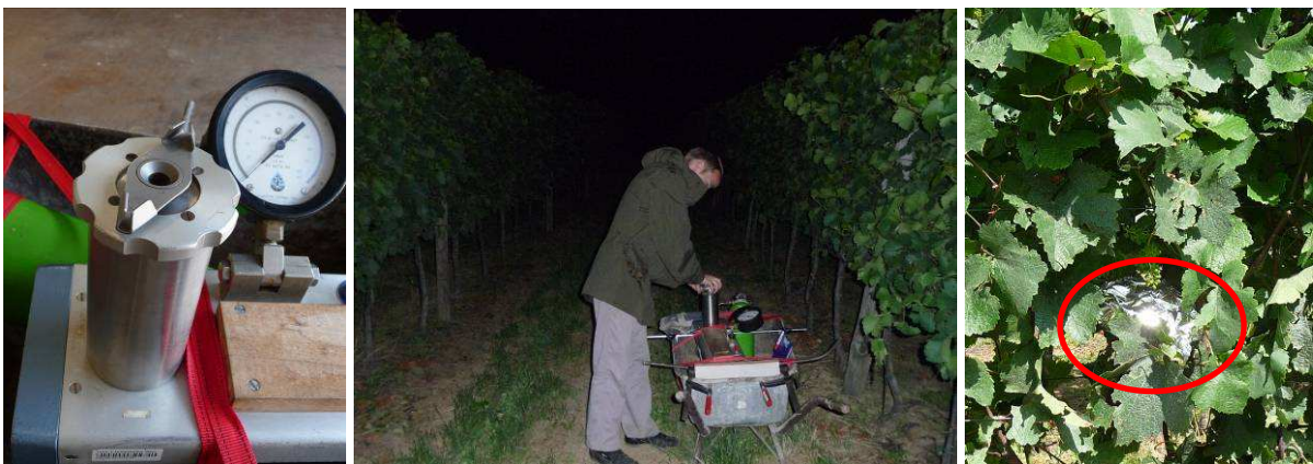
Abbildung 10: Messung des Wasserpotentials mittels Scholander Bombe (Fotos: Besser)
