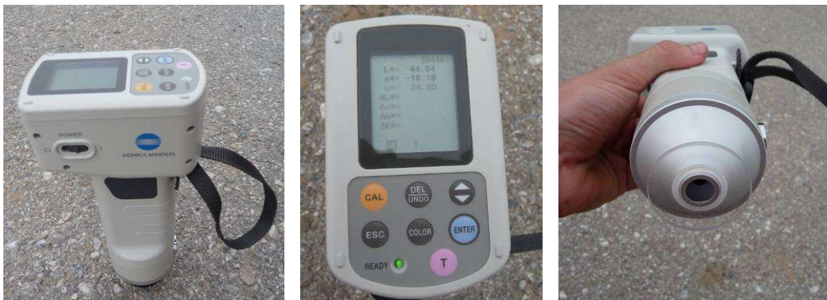
Abbildung 12: Chroma-Meter CR-400, Marke KONIKA MINOLTA (Fotos: Besser)
