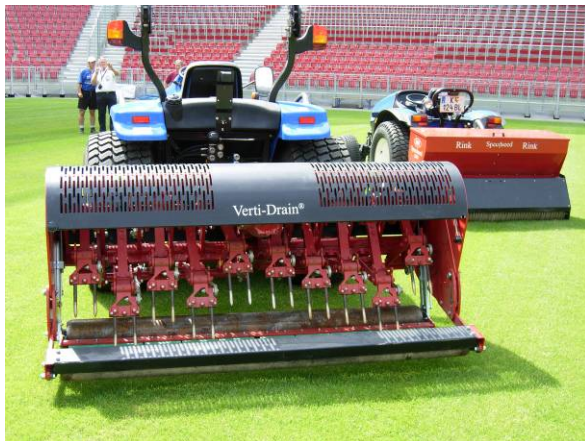
Abb. 33: links Aerifiziergerät (Quelle: http://www.lifepr.de/attachment/53500/08%2BG-S%2BAerifizieren ) und rechts Hohlzinken (Quelle: http://www.greenpower-group.at/_images/dienstleistungen/aerifizieren )
