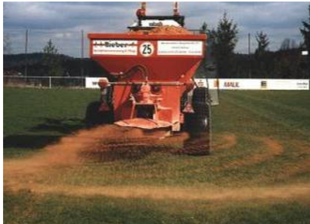
Abb. 35: links Besanden mit traktorgezogenem Streugerät (Quelle: http://www.sportplatzservice-mh.at/images/besanden_480.jpg ) und rechts Schleuderstreuer(Quelle: http://www.sportplatzpflege.de/assets/images/besanden.jpg )
