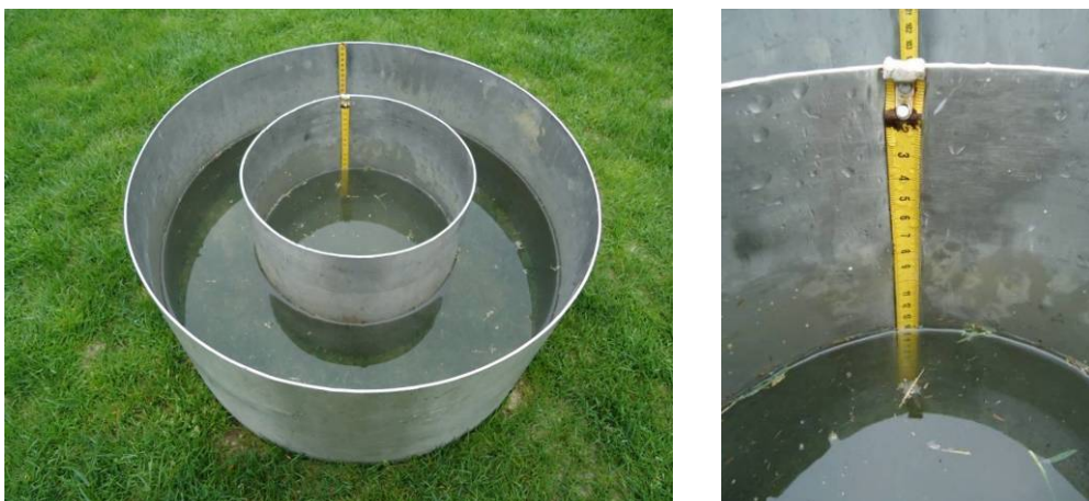
Abb. 49: Doppelring-Infiltrometer des IBLB (links) und Skala zum Ablesen des Wasserstandes (rechts)
