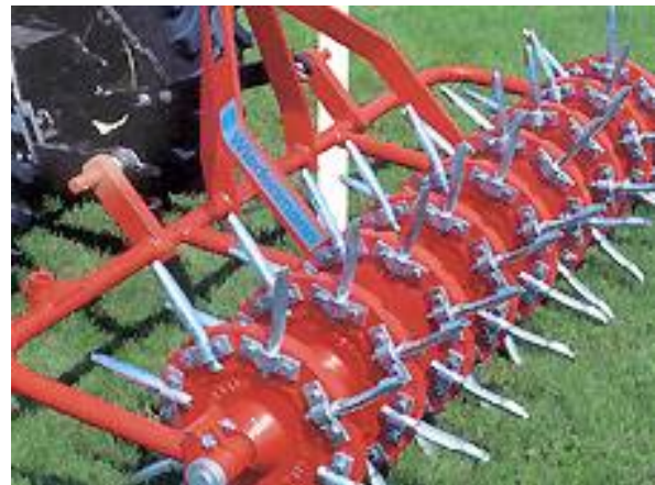
Abb. 33: links Aerifiziergerät (Quelle: http://www.lifepr.de/attachment/53500/08%2BG-S%2BAerifizieren ) und rechts Hohlzinken (Quelle: http://www.greenpower-group.at/_images/dienstleistungen/aerifizieren )
