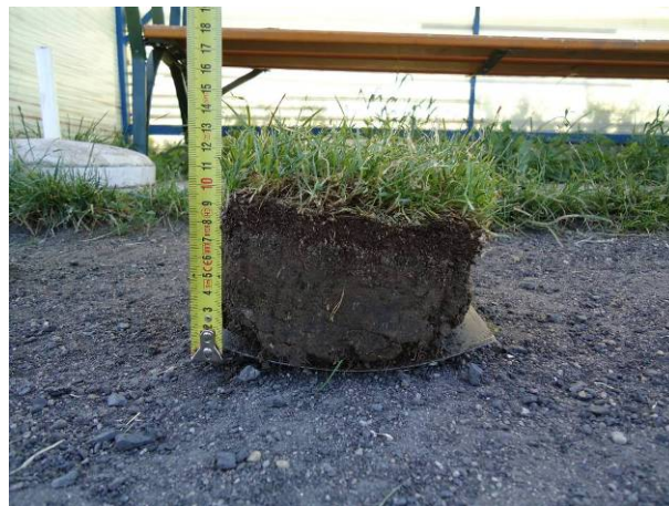
Abb. 77: Durchwurzelungstiefe LA Riverside Liesing Wien, 07/2010
