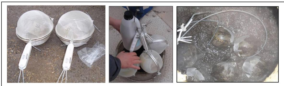
Abbildung 45: Einbringung der Proben in den Fermenter
