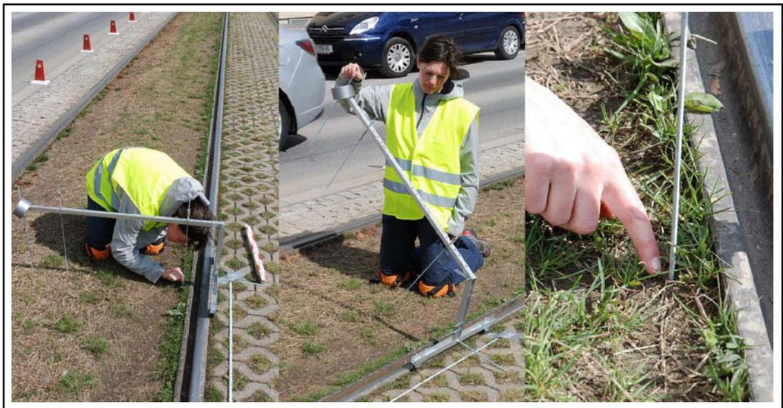
Abbildung 82: Vegetationsaufnahme auf der Versuchsstrecke in der Conrad von Hötzendorfstraße im Mai 2010. Für die Vegetationsaufnahme unter den schwierigen Bedingungen auf dem Straßenbahngleis wurde ein Aufnahmegerät konstruiert, dass sich entlang der Schienen fortbewegen lies. Ein Maßband wurde neben den Schienen aufgeklebt und der Balken des Geräts alle 8 cm abgesenkt. Wenn die Spitzen der Metallstäbe des Geräts eine oder mehrere Pflanzen berührten, wurden diese aufgenommen (SCHARF, Mai 2010).
