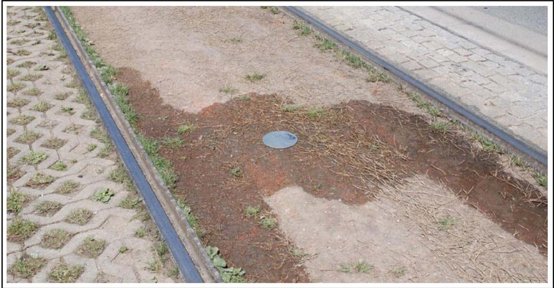
Abbildung 111: Ermittlung der Wasserdurchlässigkeit mittels Ausschüttversuch im Mai 2010. Dabei wird eine definierte Menge Wasser über eine Prallplatte, die am Boden aufgelegt wird, ausgeschüttet und die Versickerungszeit gemessen (SCHARF Mai 2010). Die Versuchsstrecke zur Gleisbegrünung befindet sich in der Conrad von Hötzendorfstraße in Graz.
