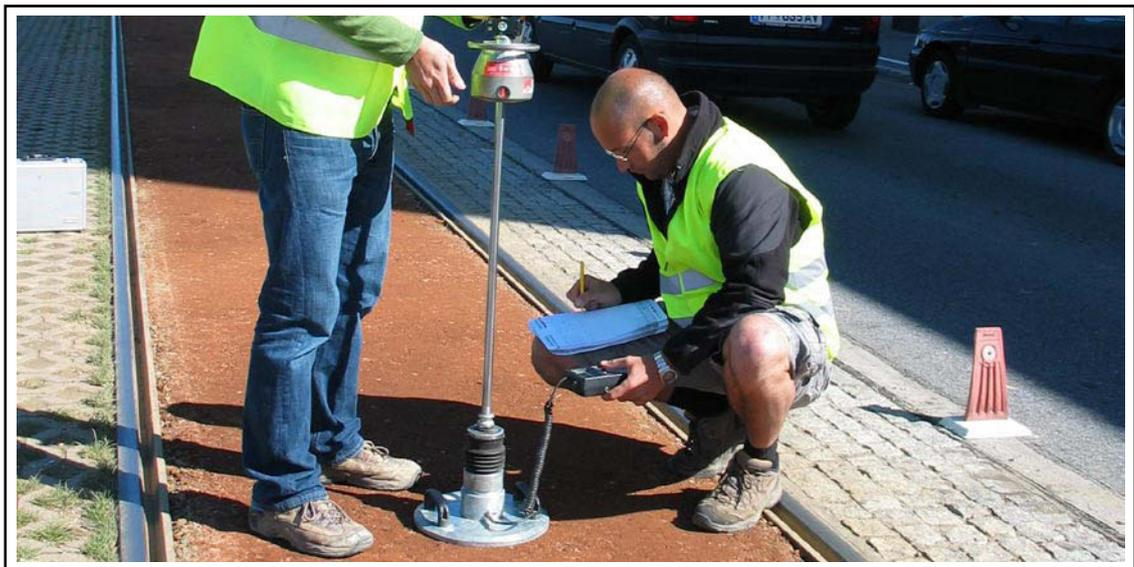
Abbildung 107: Messung der Tragfähigkeit der Versuchsstrecke zur Gleisbegrünung in der Conrad von Hötzendorfstraße in Graz. Nach dem Einbau der Versuchsstrecke im Mai 2009 wurde die Tragfähigkeit der Vegetationstragschicht mit einer dynamischen Lastplatte ermittelt (SCHARF Mai 2009).
