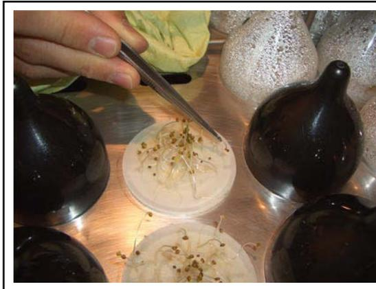
Abbildung 75: Auszählen der Keimlinge. Mit einer Pinzette werden die Keimlinge vom Filterpapier entfernt und auf ein schwarzes Blatt Papier ausgelegt, wo sie in die unterschiedlichen Kategorien eingeteilt werden.
