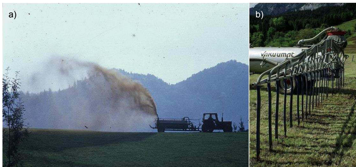
Abbildung 27: Ausbringung von Gülle/Gärrest: a) Breitverteilung mittels Prallteller (Foto: K. Buchgraber); b) Schleppschlauchtechnik (Foto: E.M. Pötsch).
