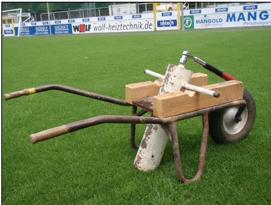
Abbildung 11: Stollenschergerät mit aufgesetztem Drehmomentschlüssel. Scholz-Arena Aalen. 15.7.2010
