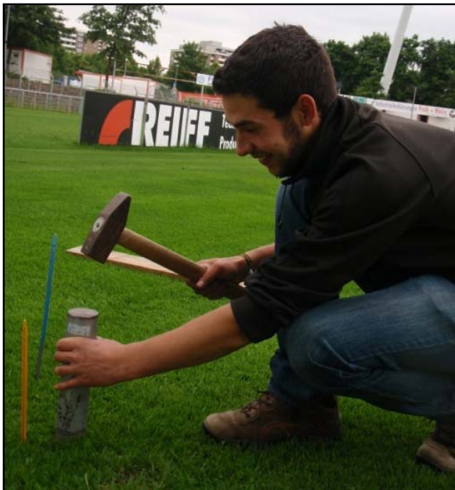
Abbildung 38: Einschlagen der Stechzylinder mit Schlagkopf und Schlägel. Stadion an der Kreuzeiche Reutlingen. 1.7.2010
