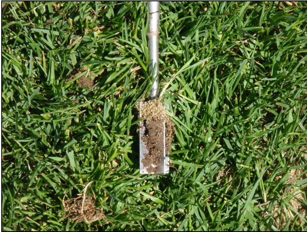
Abbildung 16: Flügelsonde, unterer Teil: Sondierstange und Flügel mit Bodenrückständen nach der Messung. Mercedes-Benz-Arena Stuttgart. 6.7.2010
