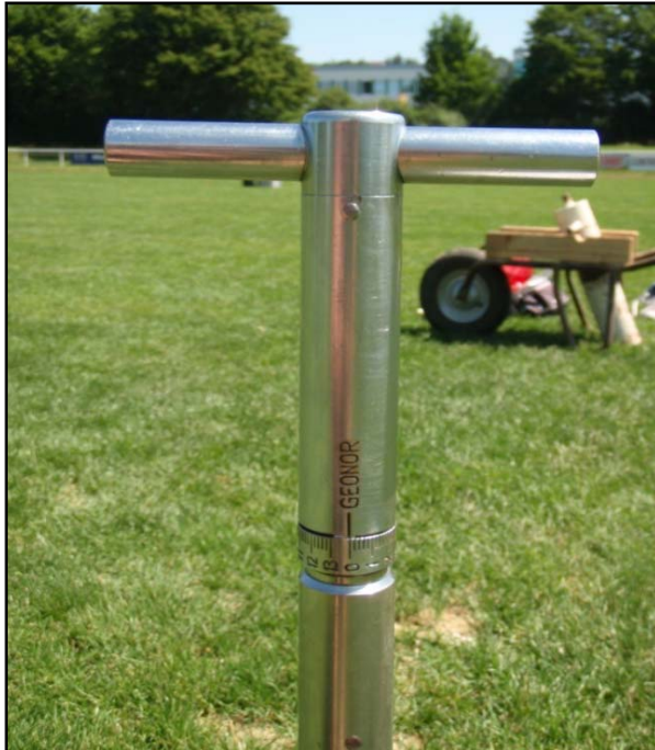
Abbildung 14: Detailansicht der Flügelsonde: Schiebering mit Skaleneinteilung. Weiherstadion Hechingen. 5.7.2010
