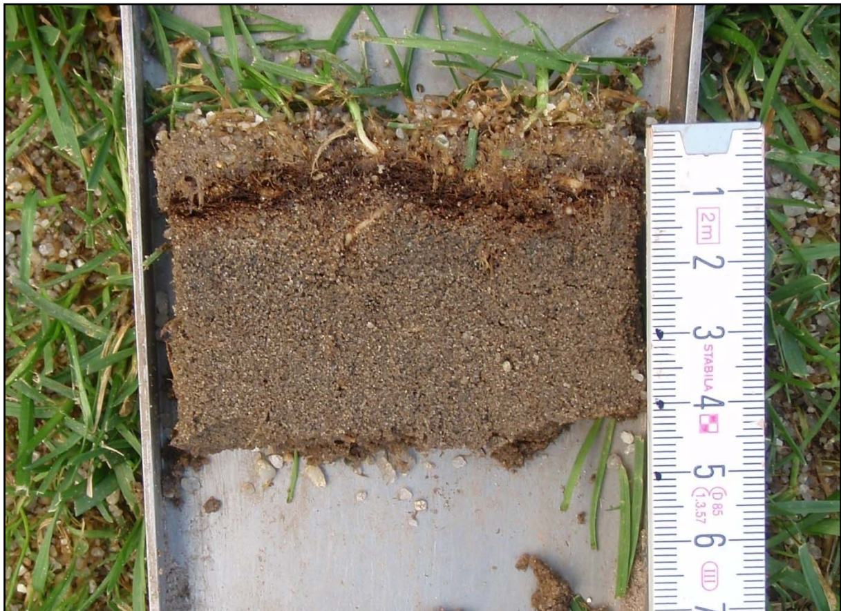
Abbildung 34: Rasenfilzanhäufung am Bodenprofil. Impuls-Arena Augsburg. 28.9.2010
