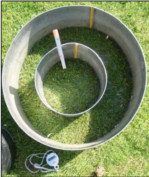
Abbildung 24: Das Absinken des Wasserspiegels im inneren Zylinder wird mit einer Stoppuhr gemessen. Station an der Kreuzeiche Reutlingen. 1.7.2010
