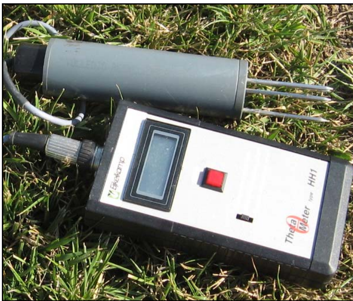
Abbildung 36: Thetaprobe, das Messgerät für den volumetrischen Bodenwassergehalt von 0 bis 55 mm. Sportplatz der Universität Hohenheim. 30.6.2010
