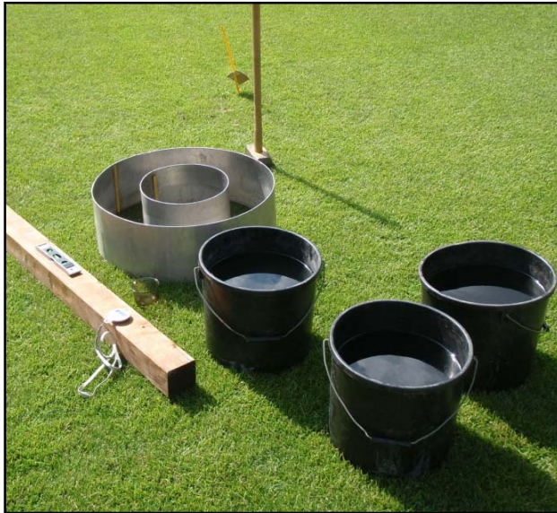
Abbildung 22: Doppelringinfiltrometer mit Zubehör. Mercedes-Benz-Arena Stuttgart. 6.7. 2010
