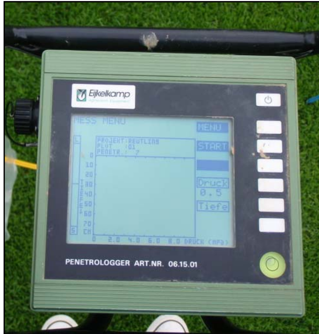
Abbildung 18: Datalogger des Penetrometers. Stadion an der Kreuzeiche Reutlingen. 1.7.2010
