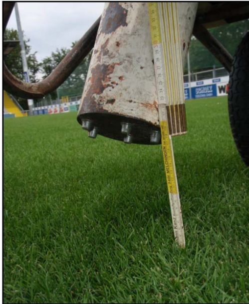
Abbildung 12: Fallenlassen des Eisenzylinders aus definierter Höhe. Scholz-Arena Aalen. 15. 7. 2010
