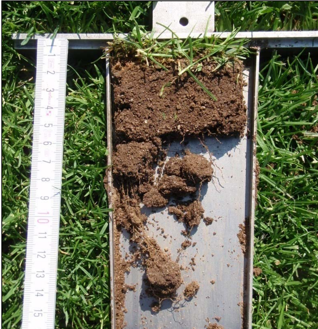
Abbildung 35: Abbruchhorizont und maximaler Wurzeltiefgang eines Bodenprofils. Weiherstadion Hechingen. 5.7.2010
