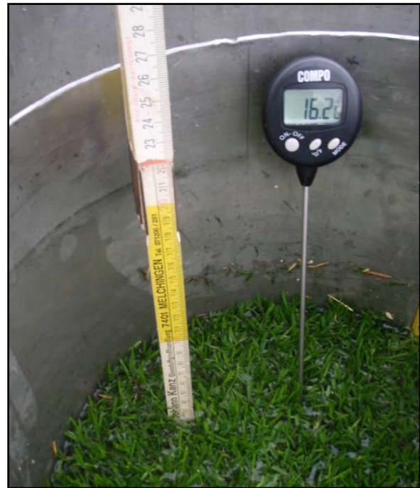
Abbildung 25: Wasserspiegel- und Wassertemperaturmessung im inneren Zylinder. Station an der Kreuzeiche Reutlingen. 1.7.2010
