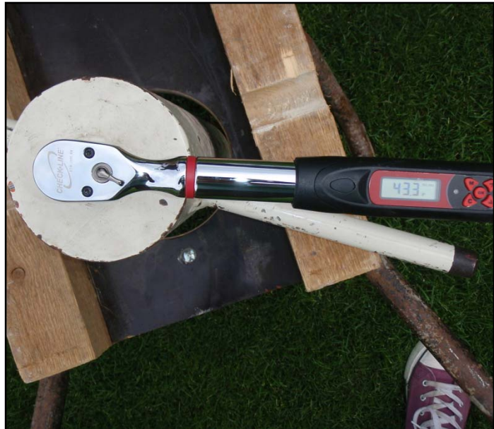
Abbildung 13: Anzeige des Drehmomentes, um den Zylinder bis zur Markierung zu drehen. Scholz-Arena Aalen. 15.7.2010
