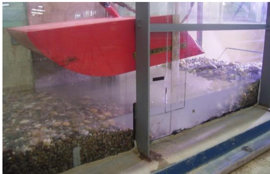
Abbildung 47: links: Modellversuch Schwingklappe unter Einfluss von Geschiebetrieb (Bernhart et. al., 2009), rechts: Wirbeldrossel mit einer Einlauföffnung
