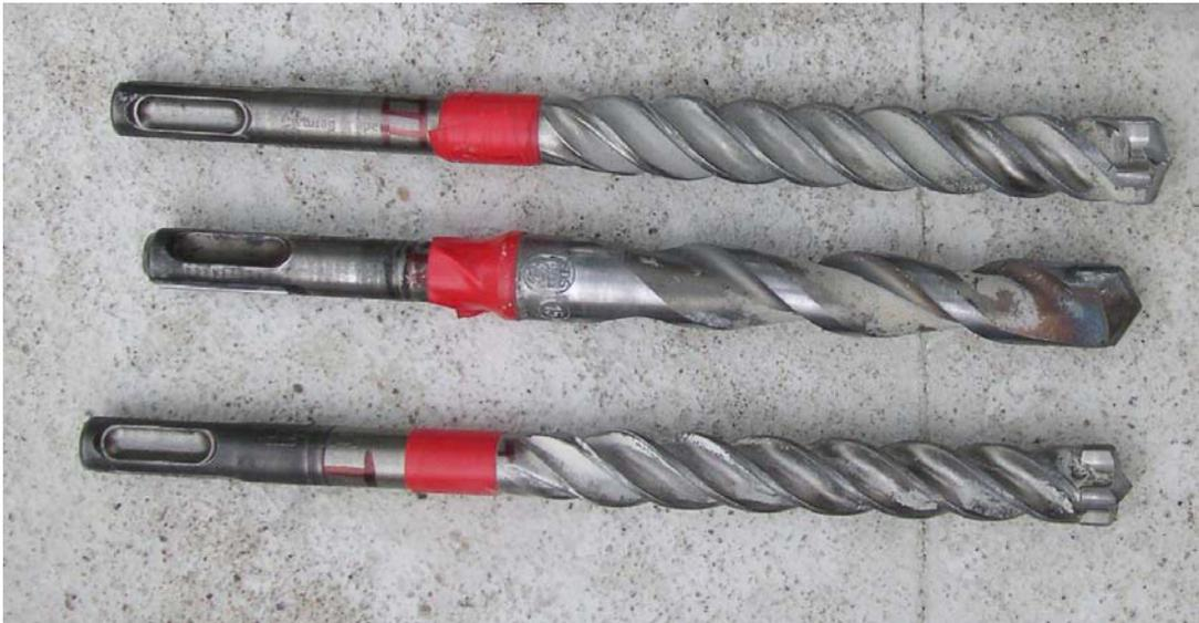
Abbildung 42: Bohrer mit unterschiedlichem Bohreckmaß und Spiraldurchmesser
