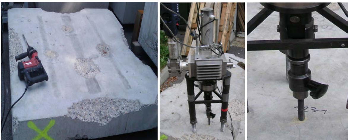
Abbildung 28: links: Betonplatte mit Bohrhammer; mitte: Prüfmaschine; rechts: Adapter
