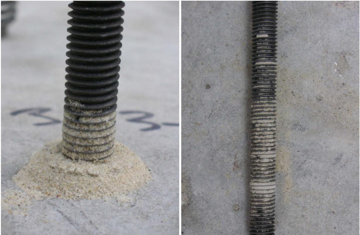
Abbildung 41: links: Gewindestange während des Ausziehvorganges; rechts: Sand an der gezogenen Gewindestange
