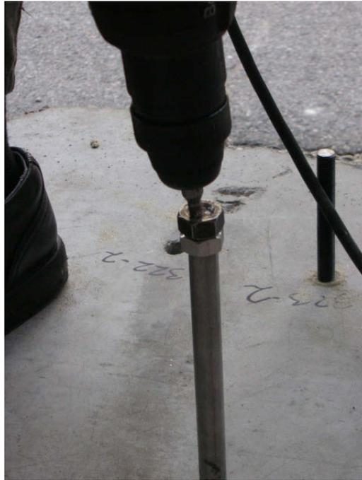
Abbildung 38: Stopfversuch mit Hüllrohr und Adapter
