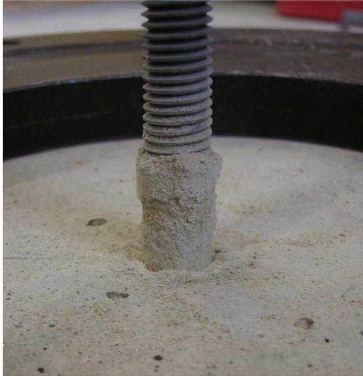
Abbildung 51: Gewindestange während Ausziehvorganges
