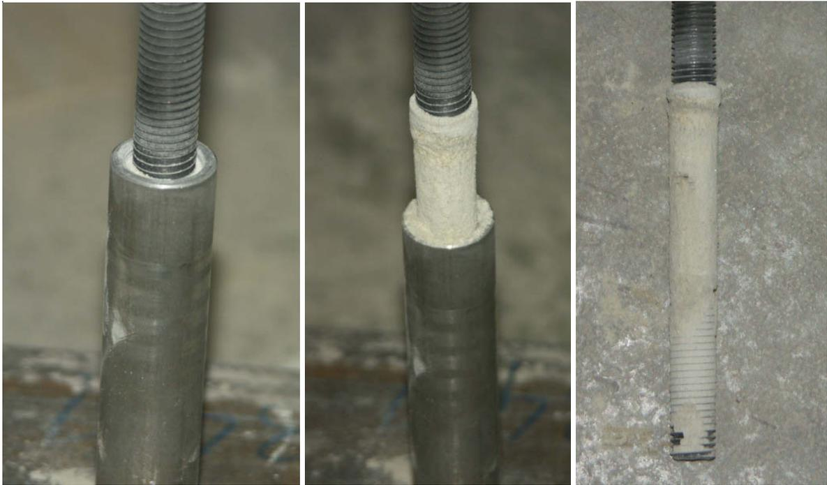
Abbildung 58: Innengewindeversuch: Verschiedene Stufen beim Ausziehvorgang
