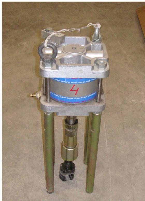
Abbildung 71: Drucktopf zum Aufbringen der Last bei den Dauerstandsversuchen
