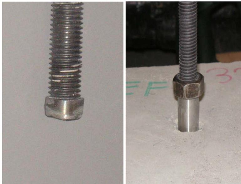
Abbildung 60: links.: Angeschweißter Ring; rechts.: Hüllrohr zum Einleiten der Vorspannkraft
