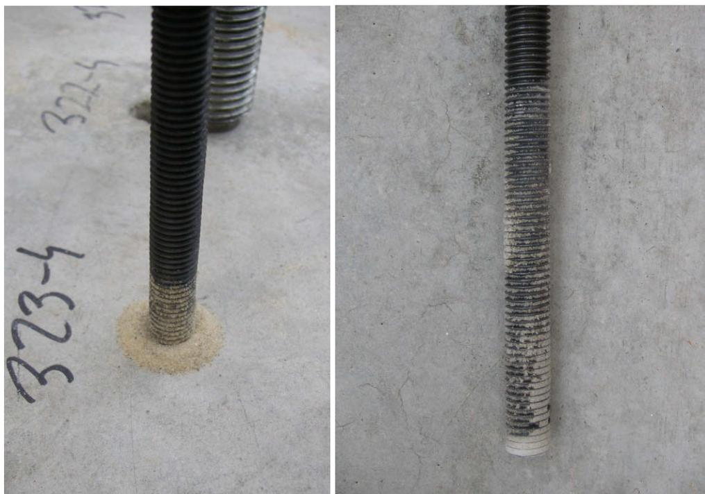
Abbildung 37: Gewindestange während und nach herausziehen aus dem Bohrloch
