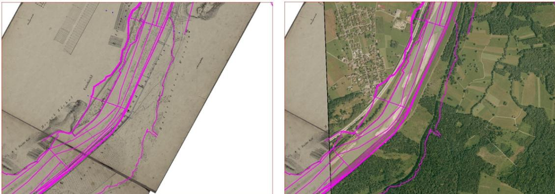
**Abbildung 5.11.:** Ausschnitt aus dem Lageplan oberhalb der Illmündung: Links des Rheins die Gemeinde Büchel, rechts die damalige Mündung des Leimbachs. Linkes Bild: definierte Bruchkanten (rosarot) aus dem historischen Lageplan. Rechtes Bild: Ein aktuelles Orthophoto wurde über den historischen Lageplan gelegt. Die historisch definierten Bruchkanten prägen teilweise immer noch das Landschaftsbild.
