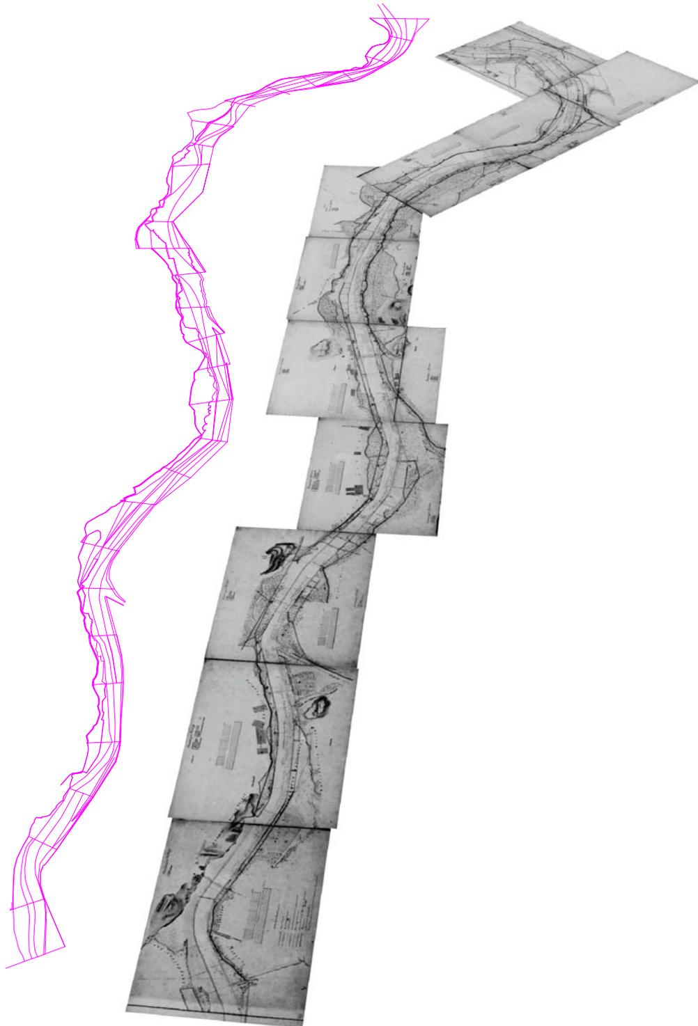
**Abbildung 5.7.:** Lageplan des Untersuchungsgebiets (Quelle: AdR). Rosarot die definierten Bruchkanten des Flusslaufs.
