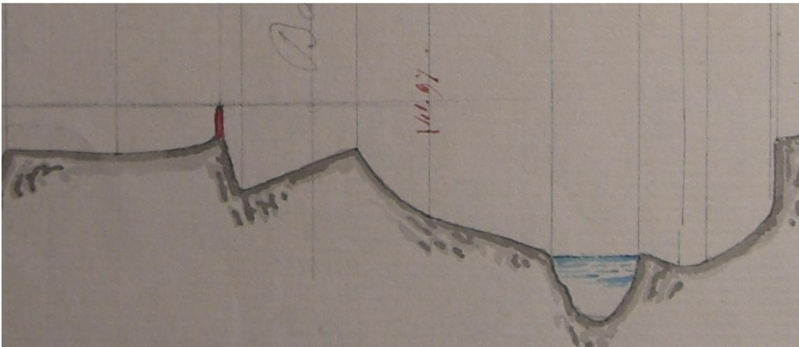
**Abbildung 7.14.:** Querprofil 70 mit einem natürlich ausgebildeten „Mittelgerinne“ (Quelle: SASStG)
