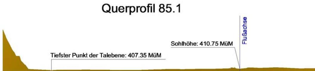
**Abbildung 5.13.:** Ein aus dem DGM generiertes Querprofil über den gesamten Talboden im unteren Bereich des Untersuchungsgebiets: Es ist ersichtlich, dass der Talboden sich einige Meter unter der Sohlage befindet und der Alpenrhein in erhöhter Lage über der Talebene fließt.
