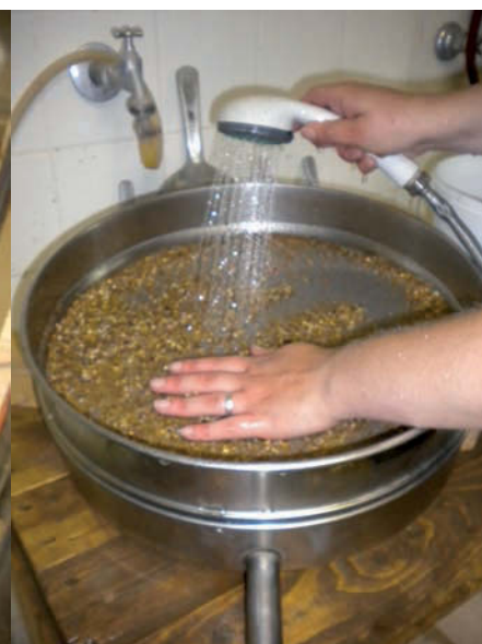
Abbildung 67: Schlämmlen der gewässerten Probe durch ein 0,5 mm Sieb, Bodenzlabor des Institutes für Geotechnik, BOKU, Wien, 2010
