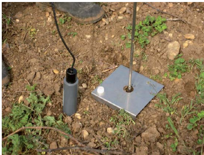
Abbildung 54: Messung mit dem Penetrologger im Feld, Riede „Äußerer Kirchberg“, Neusiedl am See, 2010
