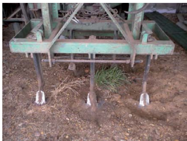
Abbildung 49: Grubber mit fünf Herzscharen von Hans PRESCHITZ, Weiden am See, 2010
