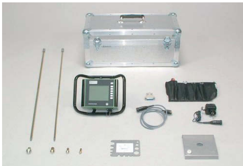
Abbildung 53: Penetrologger - Set 06.15.SA der Firma Eijkelkamp (EIJKELKAMP 2011)
