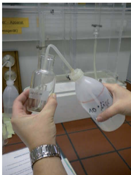
Abbildung 62: Einfüllen der HCl – Lösung in das Glasgefäß, Bodenlabor des Institutes für Ingenieurbiologie und Landschaftsbau, BOKU, Wien, 2010
