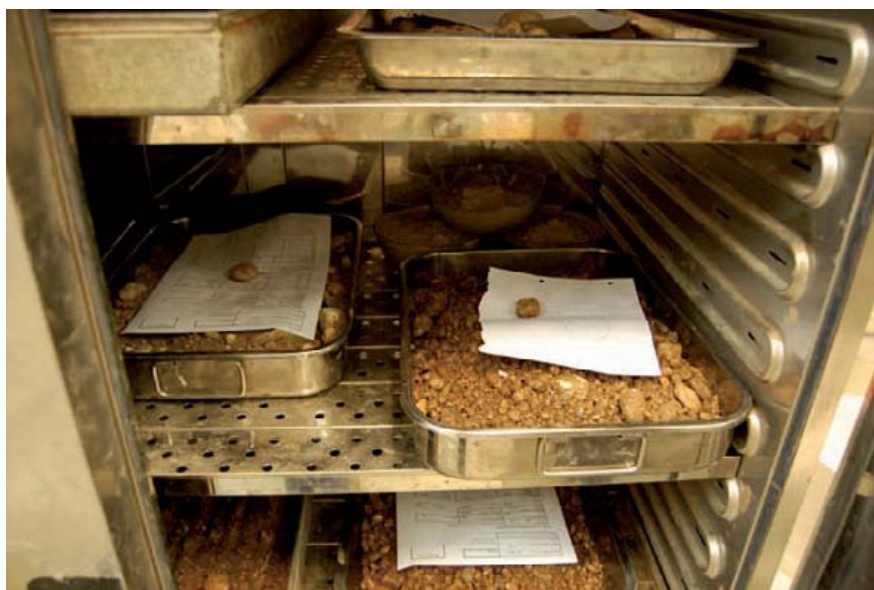
Abbildung 66: Trocknung der Proben im Trockenstand, Bodenzlabor des Institutes für Geotechnik, BOKU, Wien, 2010
