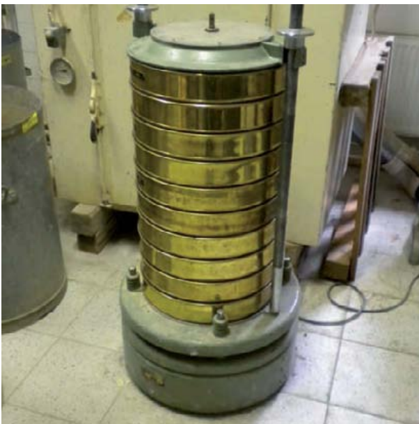
Abbildung 68: Siebturm für die Grob- und Mittelsiebung, Bodenlabor des Instituts für Geotechnik, BOKU, Wien, 2010
