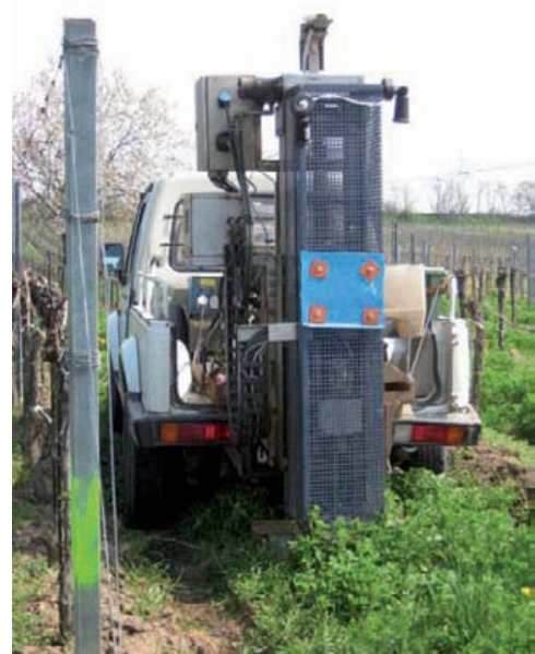
Abbildung 55: Messgerät Bodenanalyse der Firma PECK, Messung der Nährstoffgehalte, Riede „Äußerer Kirchberg“, Neusiedl am See, 2010
