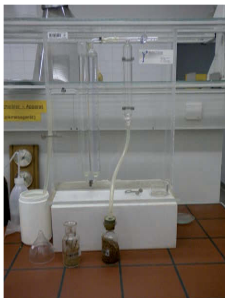
Abbildung 61: Scheiblerapparat, Bodenlabor des Institutes für Ingenieurbiologie und Landschaftsbau, BOKU, Wien, 2010
