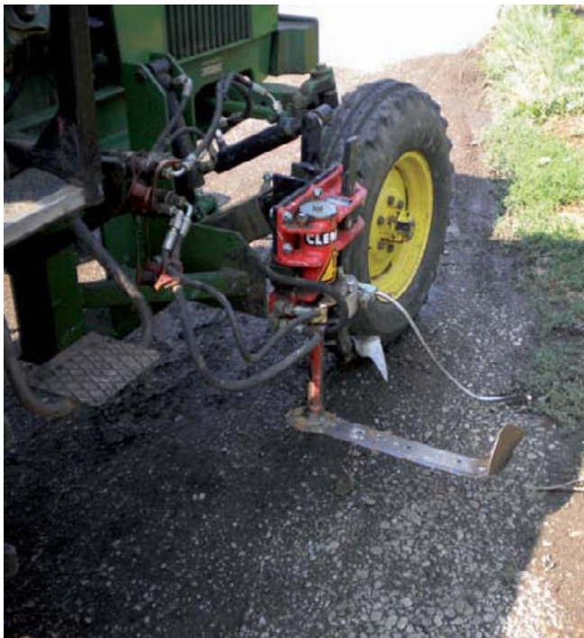
Abbildung 14: Stockräumgerät von Hans PRESCHITZ, Weingut Preschitz, Neusiedl am See, 2010
