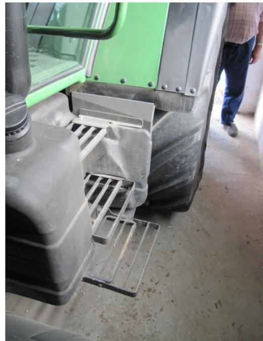
**Bild 8: Vergrößerung der Auftrittbreite im Eigenbau (Quelle: Fechter M.) (2007)**
