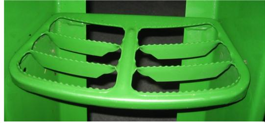
**Bild 26: Optimaler Trittstufentyp für die Erneuerung von Trittstufen bei Gebrauchstraktoren (2010)**
