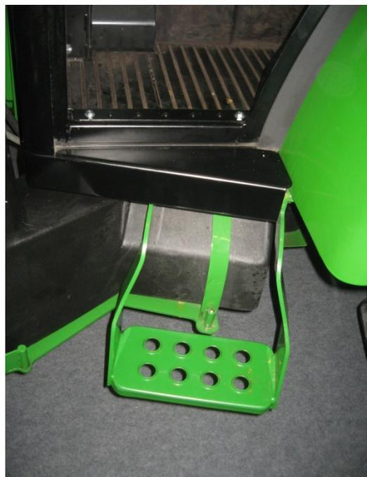
**Bild 12: Rutschsicherheit wird in Frage gestellt (2010)**
