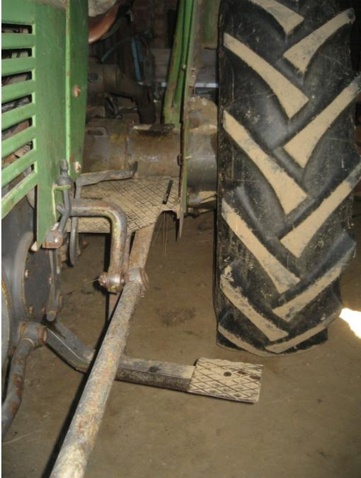
**Bild 1: Sicherheitstechnisch ungünstiger Aufstieg (2010)**
