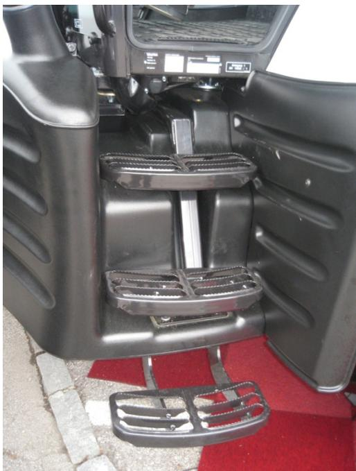
**Bild 15: Aufstieg im Tank integriert (2010)**
