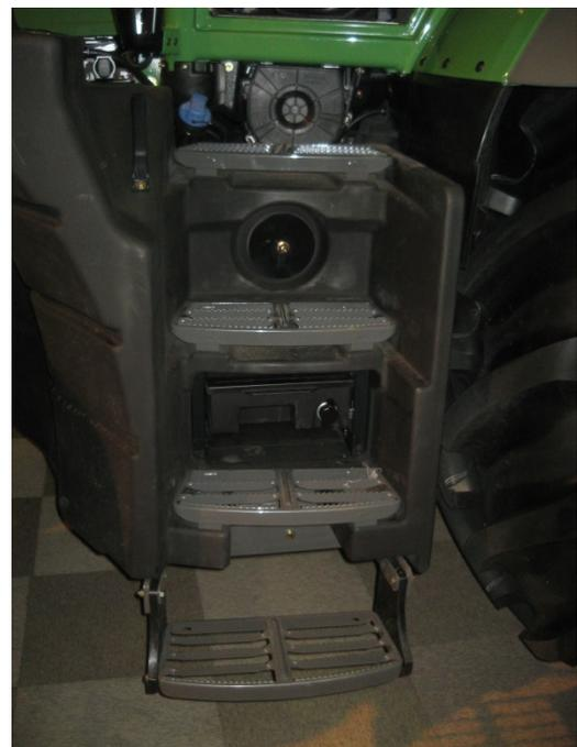
**Bild 16: Trittstufen am Tank montiert, unterste Stufe beweglich (2010)**
