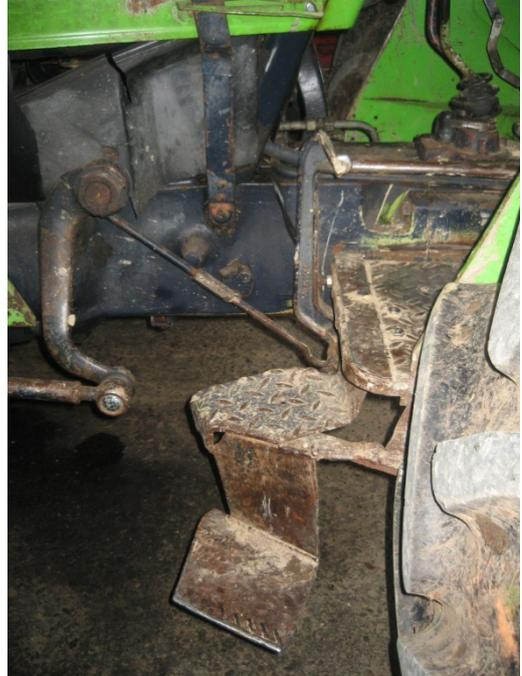
**Bild 2: Sicherheitstechnisch ungünstiger Aufstieg (2010)**
