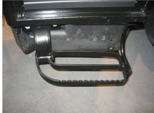
**Bild 14: Rutschsicherheit der Trittstufe fraglich (2010)**
