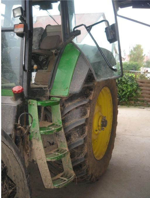
**Bild 29: Handlauf an der A-Säule könnte optimiert werden (2010)**
