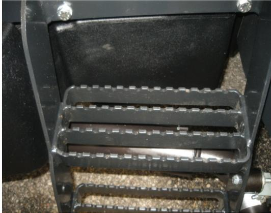
**Bild 13: Flachstähle mit glatter Oberfläche → Rutschsicherheit (2010)**
