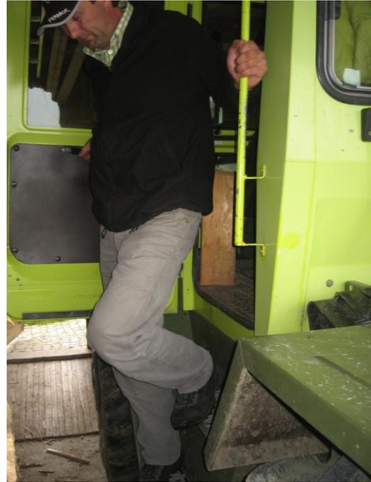
**Bild 10: Verlängerter Handlauf → Ausstieg sicherer (2010)**
