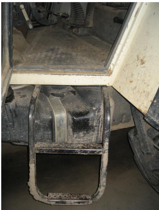
**Bild 31: Kleine Trittbretter, abgenutzte Oberfläche (2010)**
