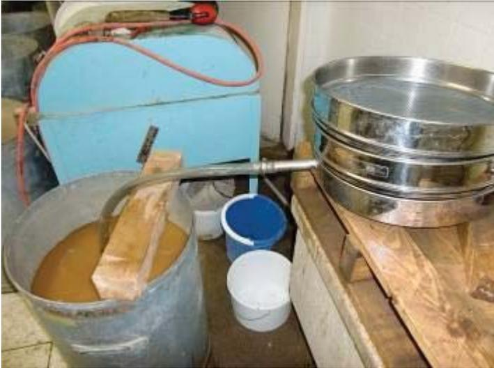
Abbildung 42: Siebturm und Schlämmtone, Bodenlabor, Institut für Geotechnik, BOKU Wien, August 2010
