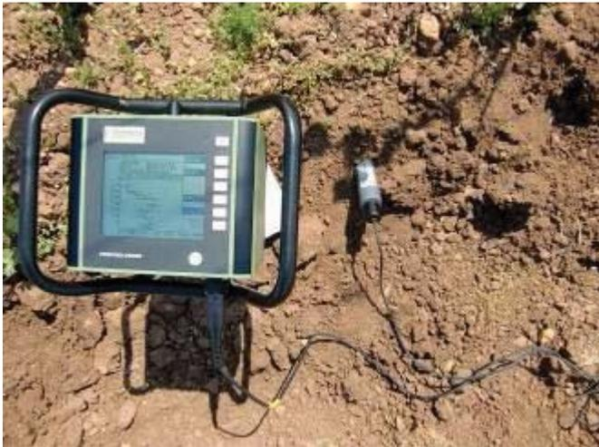
Abbildung 36: Penetrologger mit angeschlossenen Bodenfeuchtesensoren, Weiden am See, April 2010
