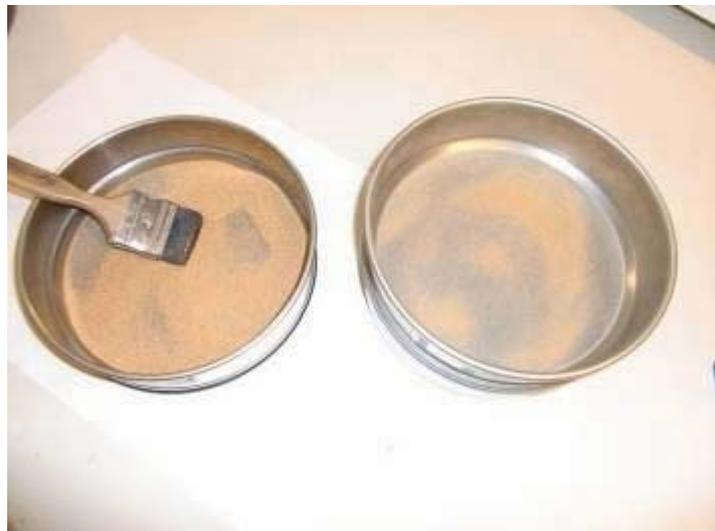
Abbildung 44: Feinsiebung, Bodenlabor, Institut für Geotechnik, BOKU Wien, August 2010
