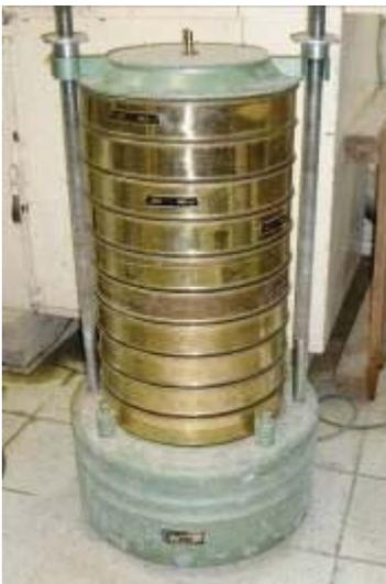
Abbildung 43: Elektrischer Siebturm für Grob- und Mittelsiebung, Bodenlabor, Institut für Geotechnik, BOKU Wien, August 2010
