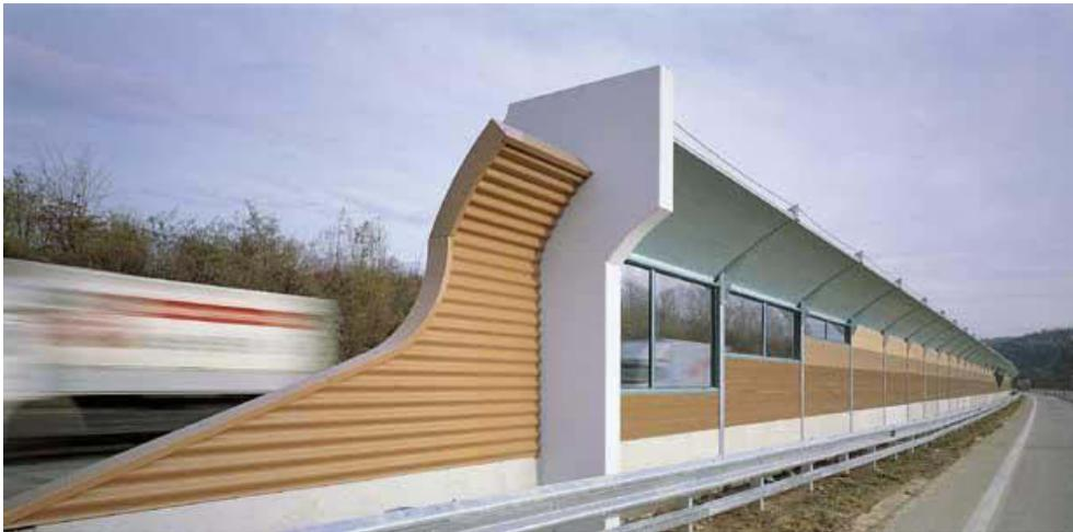
**Abbildung 5: Beispiel für eine Mittellärmschutzwand**
