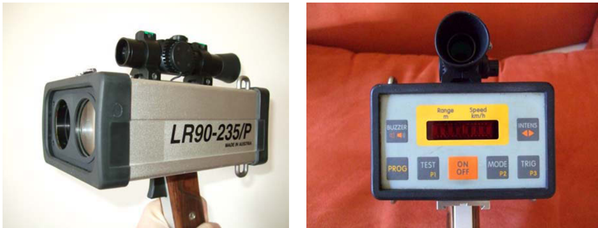
Foto 3: Laserpistole LR90-235/P, Seitenansicht und Display
