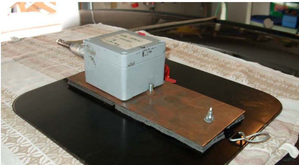
Foto 1: Beschleunigungssensor mit Magnetplatte
