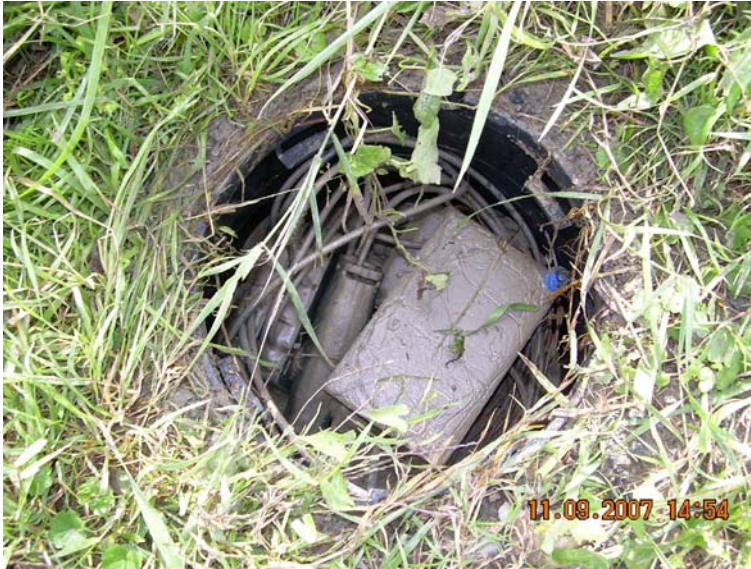
Abbildung 1.16: Zählstelle Klosterneuburg, Geräteschacht nach Hochwasser, deutliche Schlammablagerungen, Gerät aber unbeschädigt (Foto: SALZER, H.)
