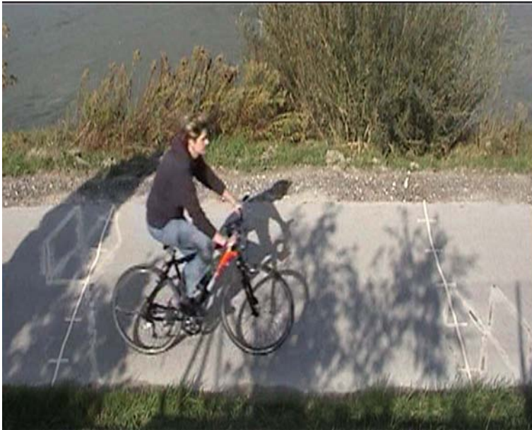
Abbildung 2.1: Zählstelle Klosterneuburg, Screenshot der Videobeobachtung; links und rechts die Markierungen zur Berechnung der Geschwindigkeit; Unterscheidung des Geschlechts oft nicht möglich
