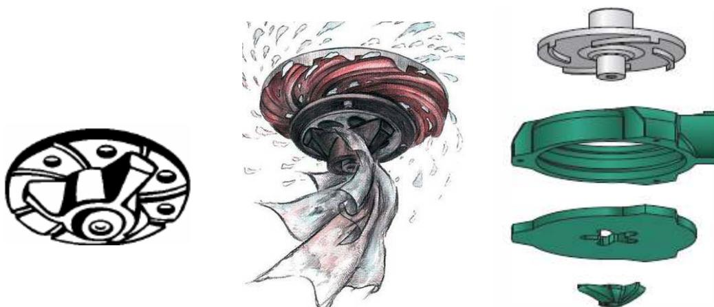
Abbildung 4-28: Laufrad mit Schneideinrichtung (JABERG, 2003; MALL, 2011; WILO, 2008)
