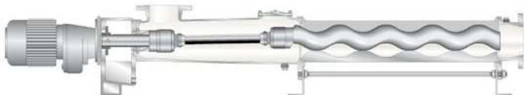
Abbildung 3-20: Exzentrerschneckenpumpe (NETZSCH, 2011)
