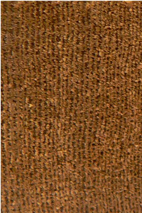
Abbildung 197: Western Red Cedar weist eine sehr geringe Dichte auf, dadurch ist das Gewicht zwar ausgesprochen gering, die Belastbarkeit wird dadurch allerdings herabgesetzt.
