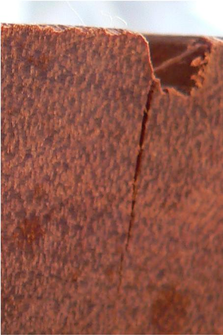
Abbildung 177: Balata ist ein sehr hartes Holz, trotzdem können bei extremer Inanspruchnahme Risse auftreten, die die Belastbarkeit des Holzes herabsetzen.
