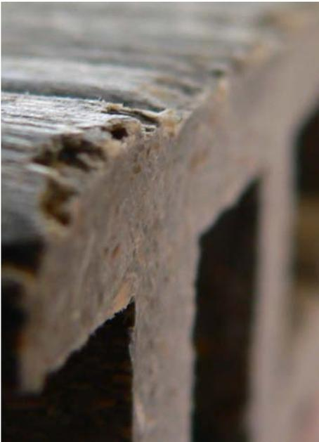
Abbildung 225: Die Kanten sind die Schwachstelle des WPC.
