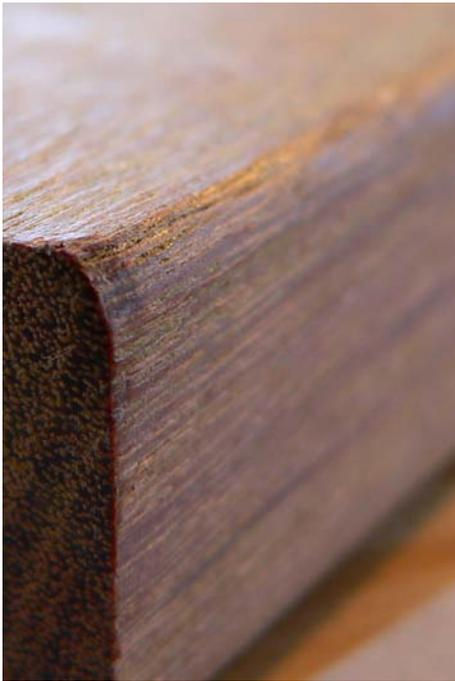
Abbildung 173: Ipé besticht durch hervorragende Werte, mit Ausnahme des hohen radialen Schwindmaßes, des Preises und dem Kriterium der Ökologie.
