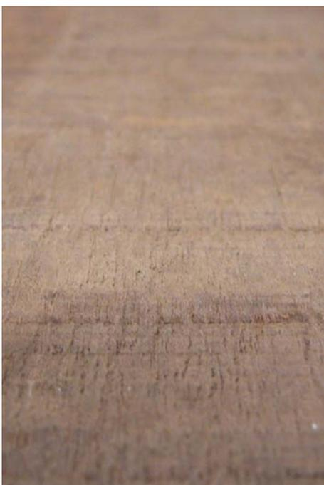
Die **Bearbeitung** des Holzes ist zwar nicht mehr von Hand möglich, mit gängigen Maschinen sind aber alle Möglichkeiten der Bearbeitung durchführbar. Hierbei ist zu beachten, dass verwendete Werkzeuge aufgrund der hohen Dichte rasch abstumpfen, ein erhöhter Verschleiß ist die Folge.<sup>32</sup>
