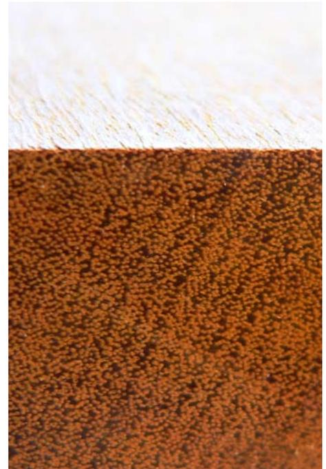
Abbildung 17 1: In der Nahaufnahme von Ipé wird die hohe Dichte und die damit einher gehende extreme Härte des Holzes deutlich.
