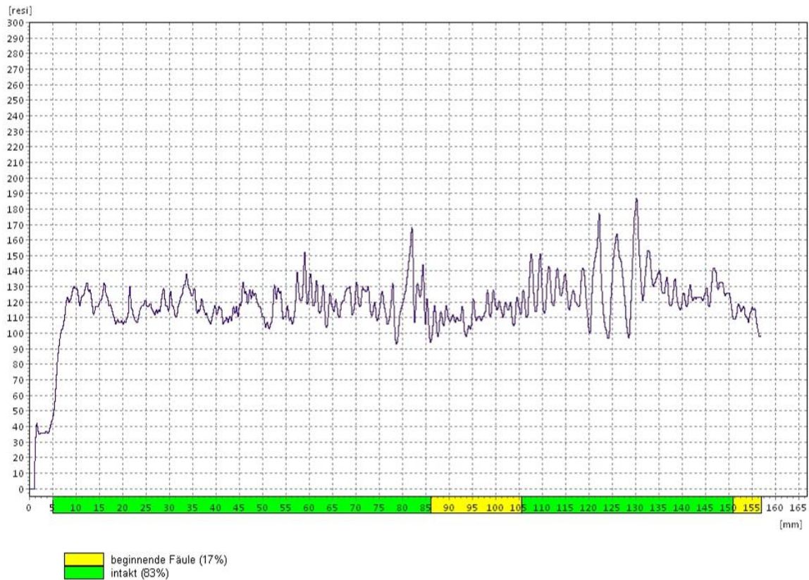
Abbildung 156156: Bohrkurve S6_L3 im Abflussbereich der Sperre 6 (Lärchenholz 1987), Wötzlgraben Matsch 08/2010
