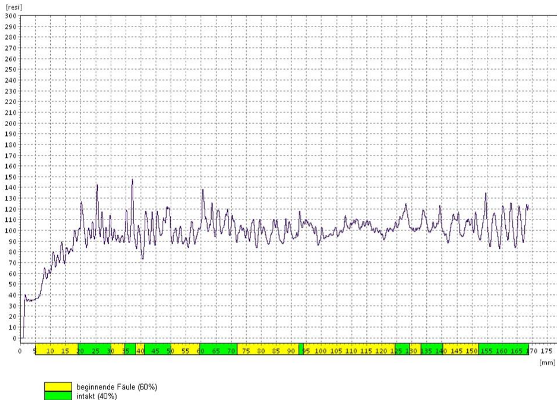
Abbildung 220220: Bohrkurve S1_L6 an der linken Schulter der Sperre 1 (Lärchenholz 1986), Pitzbach Rojen 09/2010
