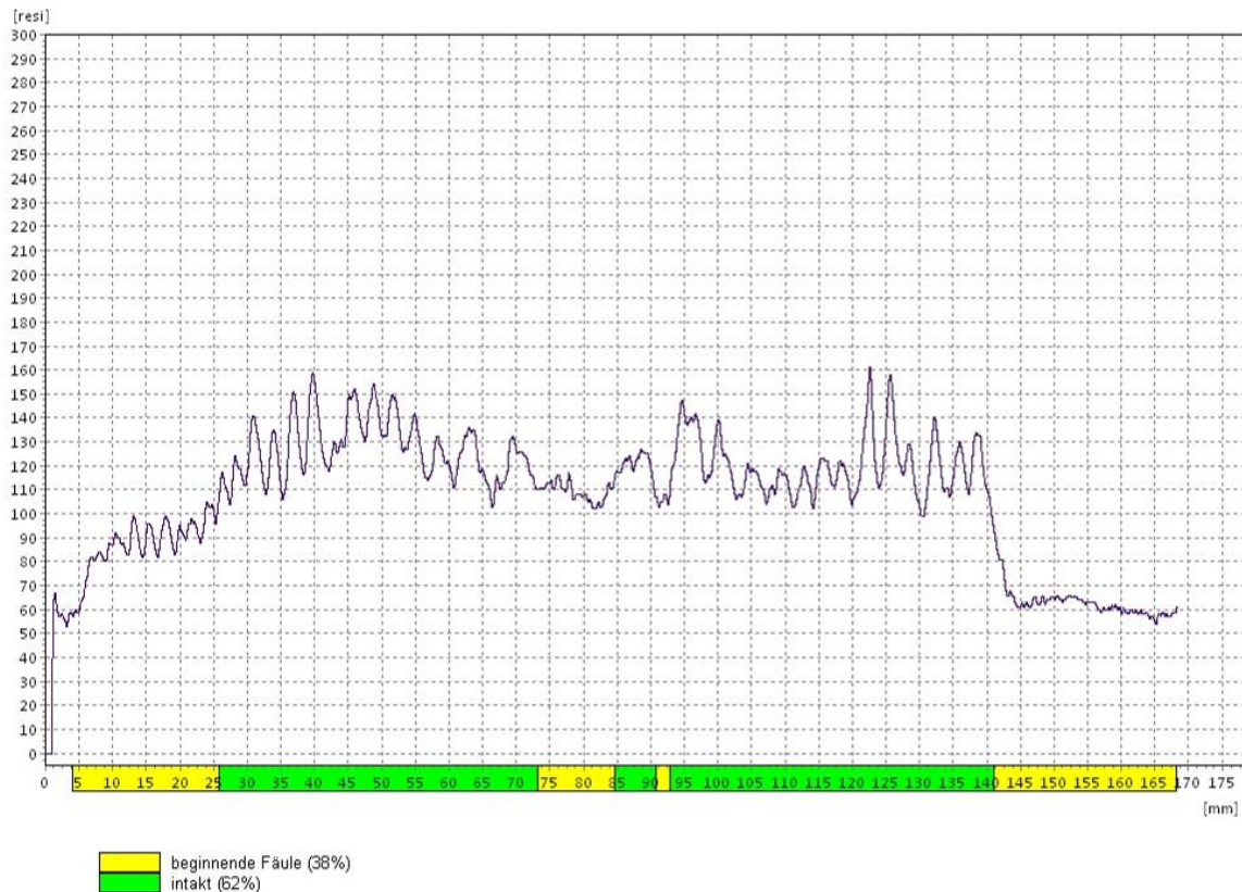
Abbildung 216216: Bohrkurve S1_L2 an der rechten Schulter der Sperre 1 (Lärchenholz 1986), Pitzbach Rojen 09/2010
