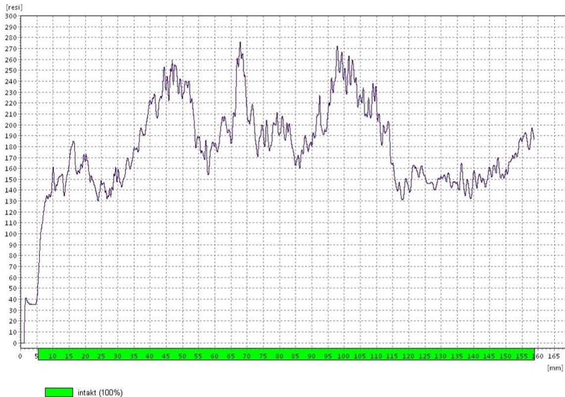
Abbildung 158158: Bohrkurve S6_L5 an der rechten Schulter der Sperre 6 (Lärchenholz 1987), Wötzelgraben Matsch 08/2010
