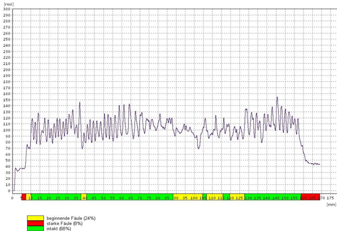
Abbildung 229229: Bohrkurve S2_Q1 an der rechten Schulter der Sperre 2 (Lärchenholz 1986), Pitzbach Rojen 09/2010
