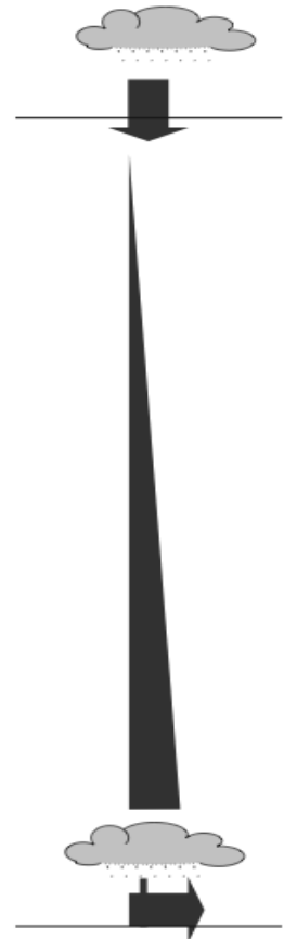
Abb. 4-4 Einfluss des Bodenbelages auf den Abflussbeiwert (MINISTERIUM FÜR UMWELT UND VERKEHR BADEN-WÜRTTEMBERG, 2003)
