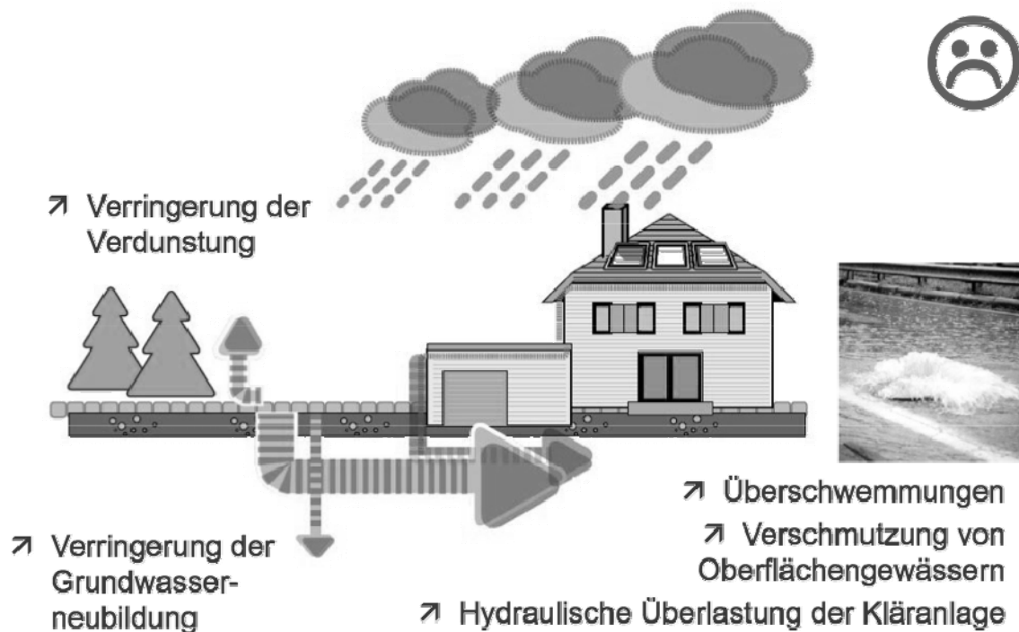
Abb. 3-9 Darstellung der derzeitigen Situation der Abflüsse häuslichen Abwassers (WEIDENHAUPT UND WERSANDT, 2009)
