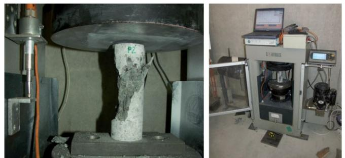
**Prüfkörper: Zylinder D = 6 cm und H = 18 cm** Fläche A = 2827,43 (mm<sup>2</sup>)
