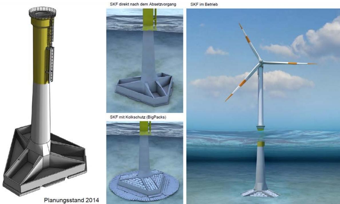
Abb. 4 Strabag Offshore Schwerkraftfundament, Planungsstand 2014
