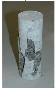
**Bild 6** Bruchlastermittlung
