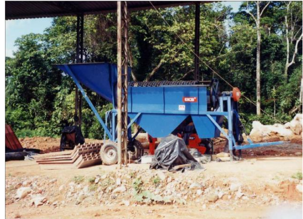
Abb. 32: Trommelsieb (nach SCHENK, 2002)
