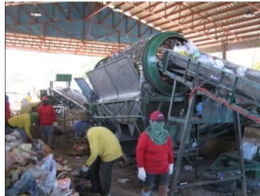
Abb. 14: Einlauf-Förderband mit rotierender Siebtrommel (nach PAUL et al., 2010)
