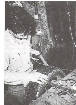
Abb. 19: Neuprofilierung mit Heißmethode (nach AHMED et al., 1996)
