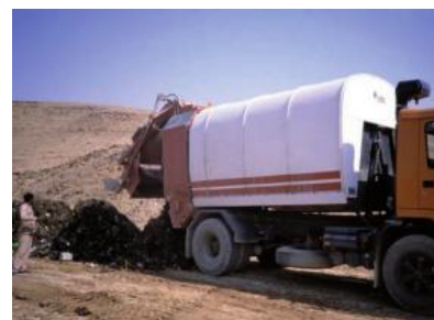
Abb. 13: Rotopressmüllfahrzeug (nach COFFEY und COAD, 2010)
