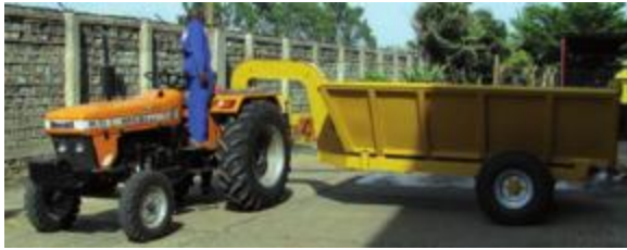
Abb. 9: Modifiziertes Anhängerdesign mit Schwanenhals, reduzierter Beladungshöhe und erhöhter Beladungskapazität (nach COFFEY und COAD, 2010)
