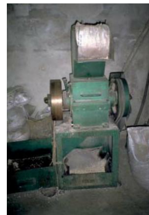
Abb. 21: Elektrisch angetriebener Shredder (nach LARDINOIS und KLUNDERT, 1995)
