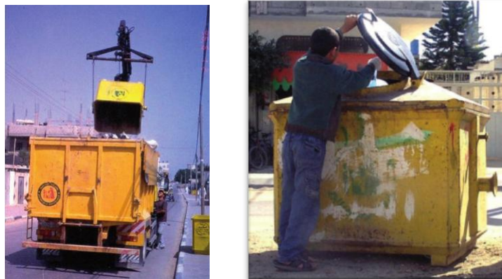
Abb. 11: LKW-Abrollkipper mit hydraulischem Kransystem und dazugehörigem Container (nach COFFEY und COAD, 2010)
