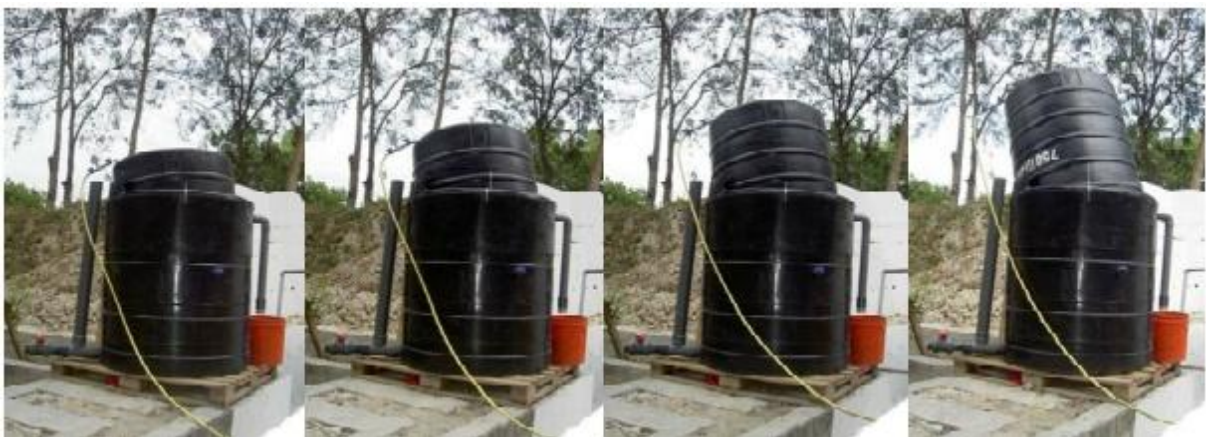
Abb. 27: ARTI-CBS; links Gasbehälter leer, rechts Gasbehälter voll (nach LOHRI, 2009)
