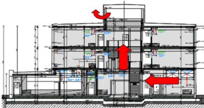
**Abbildung 47:** natürliche Nachtlüftung mit Hilfe von Klappen
