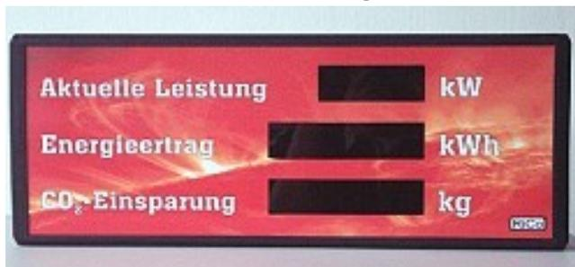
Abbildung 7: Visualisierungsmöglichkeit des PV-Ertrags. Quelle: <http://www.rico-electronic.de/>(26.03.2012)
