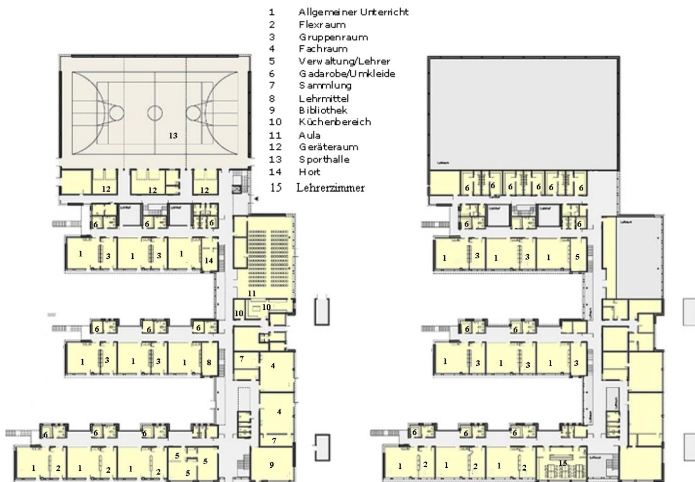
**Abbildung 24:** Darstellung des Schulgebäudes im Grundriss. Links befindet sich das Untergeschoss und rechts ist das Obergeschoss zu sehen. Quelle: [http://www.eneff-schule.de/\(13.01.2011\)](http://www.eneff-schule.de/(13.01.2011))
