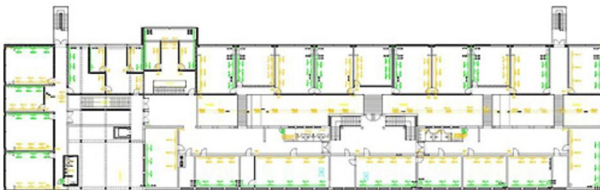
**Abbildung 22:** Darstellung des Luftverteilnetzes mit Zuluft (grün) und Abluft (gelb) über die Bereiche des Schulgebäudes. Quelle: <http://www.eneff-schule.de/index.php/Demonstrationsobjekte/Plusenergieschulen/plusenergieschule-reutershagen-rostock.html>/(13.01.2011)
