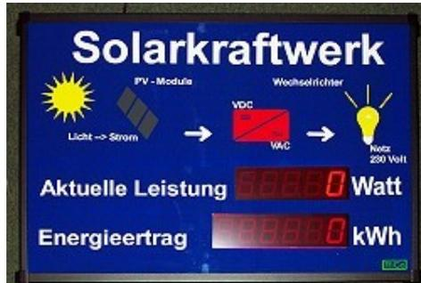
Abbildung 6: Visualisierungsmöglichkeit des PV-Ertrags. Quelle: <http://www.rico-electronic.de/>(26.03.2012)
