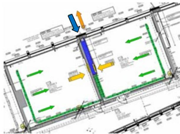
**Abbildung 44:** Darstellung eines dezentralen Lüftungskonzepts.
