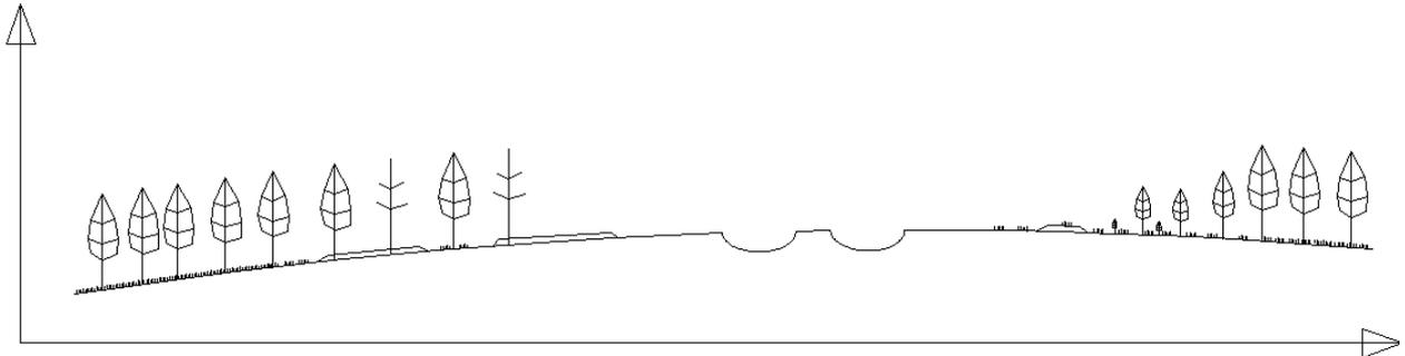
**Abbildung 23: Schematischer Querschnitt durch Vegetation im unteren Kegelbereich (nicht maßstabsgetreu, Blickrichtung bergauf) Mitte der Ablagerungen vegetationsfrei, oro links davon expandierender Bestand, Verjüngung und grasige Vegetation zum Teil auf sichtbaren Ablagerungen, oro rechts aufgelockerter Bestand im Zerfall, tote absterbende Bäume in frischen Ablagerungen, wenig Verjüngung, am Kegelrand zu beiden Seiten höhere Bäume mit Gras als Unterwuchs**
