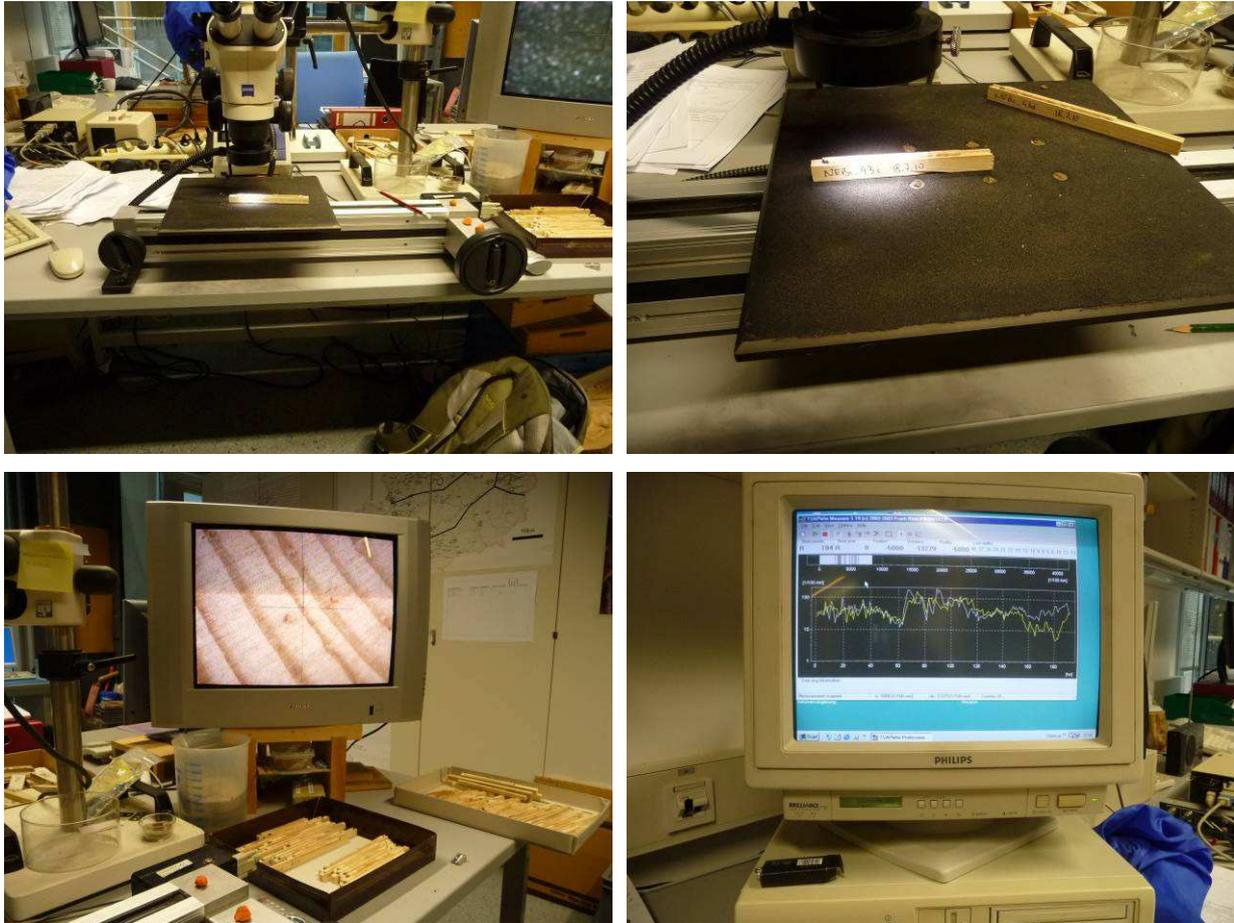
Abbildung 37: links oben Jahringmessanlage mit Stereoskop, rechts oben beschriftete Probe auf dem Messtisch, links unten Bild umgeleitet auf Fernseher, rechts unten Programm TSAPWin
