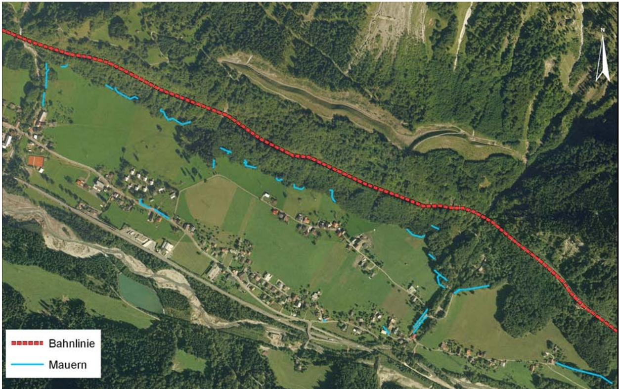
Abb. 11: Lage der Mauern und der Arlbergbahn (© VOGIS, eigene Bearbeitung)
