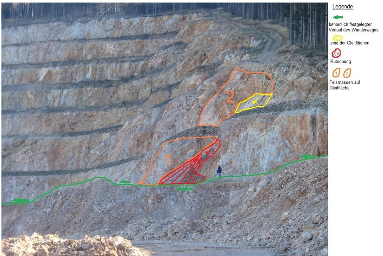
Abb. 3: Ansicht der Lage des Untersuchungsgebietes im Steinbruchbereich Lange Lisse (photogr. RABL-HOFBAUER, E., 19-11-2011)
