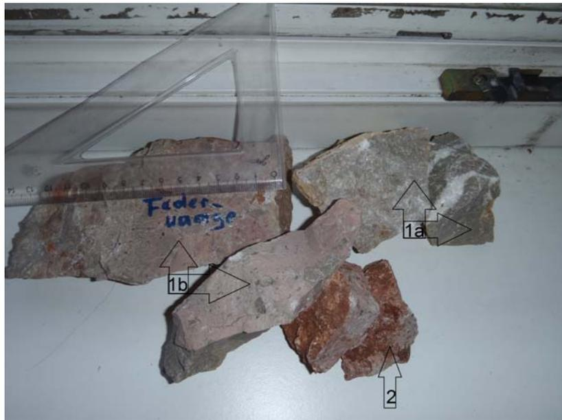
Abb. 37: Gesteine aus dem Steinbruch, Handstück für den Federwaage-Versuch (photogr. RABL-HOFBAUER, E., 16-07-2012)
