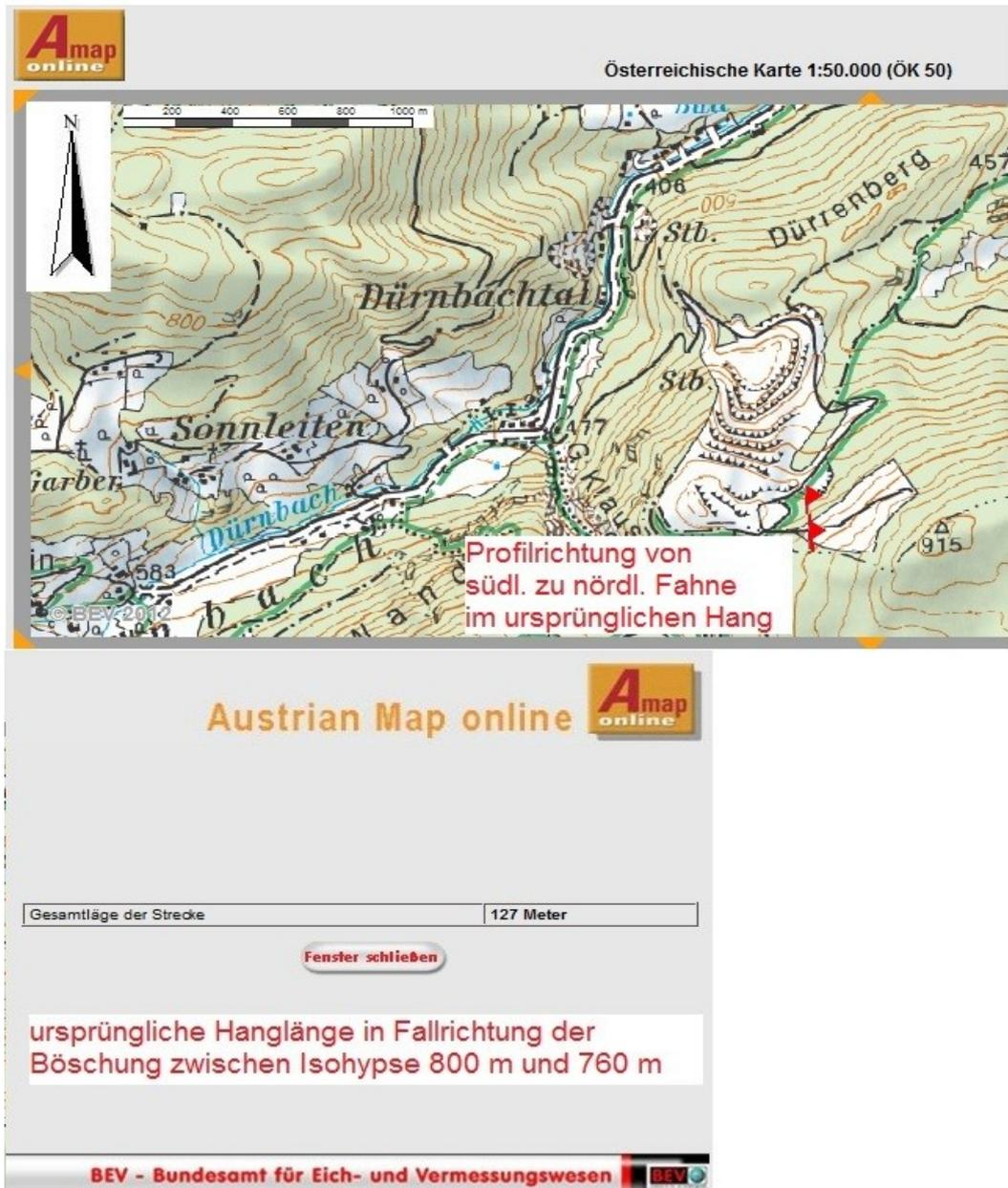
Abb. 50: Ermittlung der ursprünglichen Hanglänge über austriamap online (BUNDESAMT FÜR EICH- UND VERMESSUNGSWESEN, c, s.a.)
