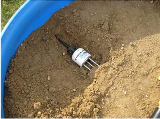
Abb. 3.11: Eingebaute TDR-Sonde Hydra-Probe 12
