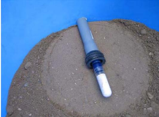
Abb. 3.13: Eingebautes Tensiometer T4
