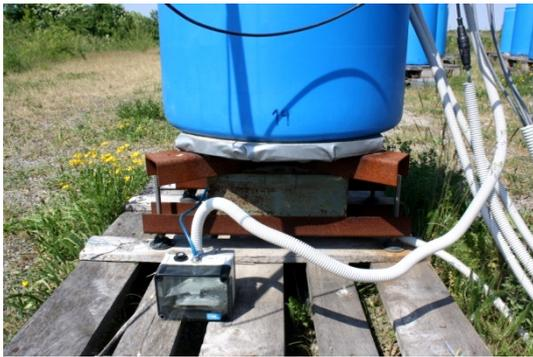
Abb. 3.1: Wiegeelektronik und Kippzähler
