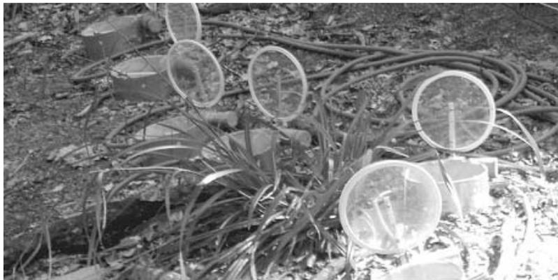
Abbildung 13: Messkammern für Bodengasemissionen (Photo vom Versuchsstandort Schotterwald aus Jahresbericht des BFW 2009 [35])
