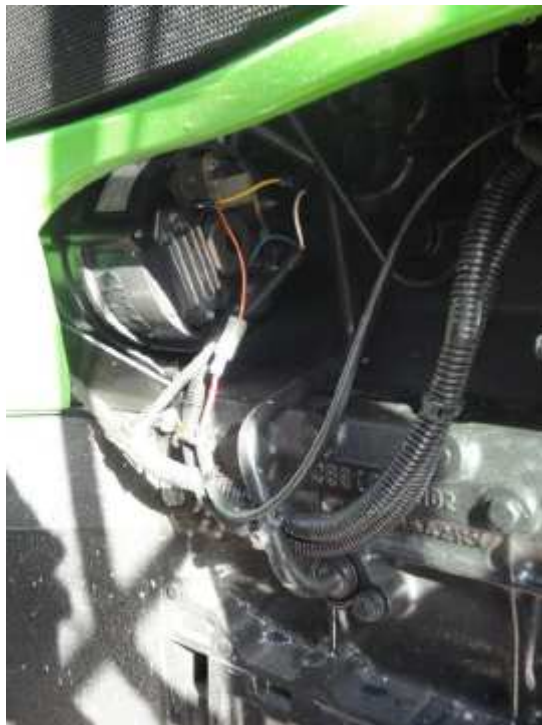
Abbildung 21: Motordrehzahlmessung an der Lichtmaschine
