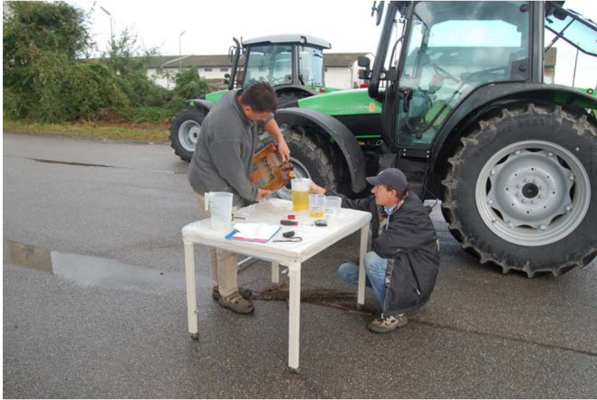
Abbildung 26: Volumetrische Messung des Kraftstoffverbrauches mittels Messzylinder und Messbecher
