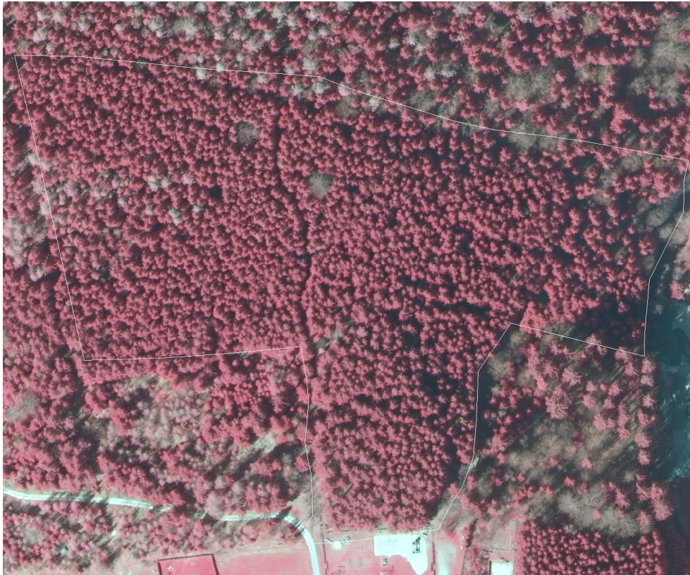
Abb. 29: Lageungenauigkeit einer Bestandesfläche aus dem GIS (weiße Linie) in Bezug auf das aktuelle Orthofoto. Die Lageungenauigkeit kann besonders an der nördlichen Bestandesgrenze beobachtet werden (Weidenbach 2008 b).
