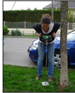
Abb. 8: Messung der Bodendichte mittels Penetrologger, Baden, 2011
