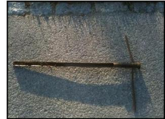
Abb. 13: Entnahme der Bodenproben mittels Bodenbohrer, Baden, 2011
