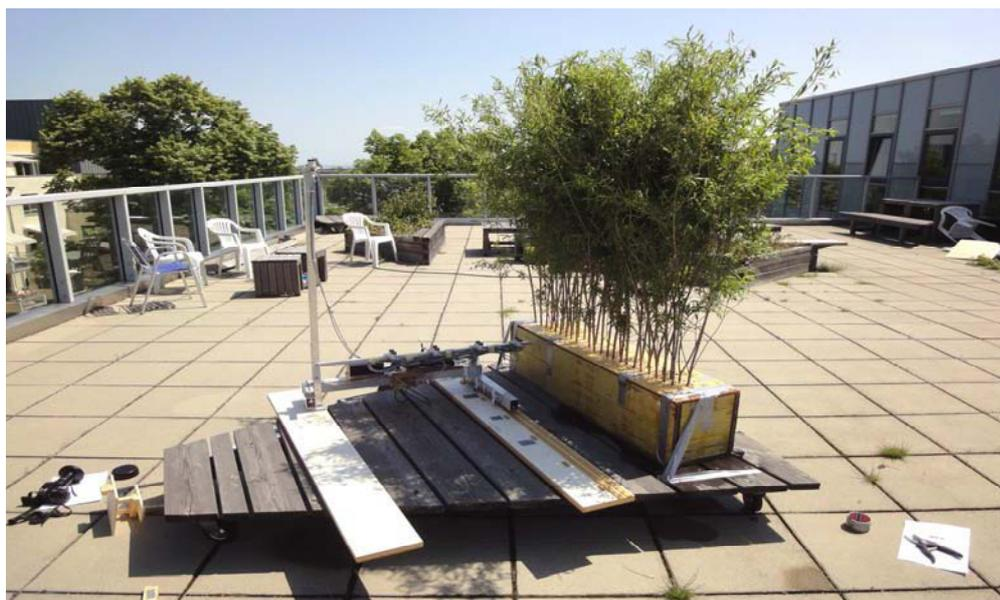
**Abbildung 3** Modellversuch zur Strahlungsdurchlässigkeit der *Salix purpurea* am 25.05.2011 auf der Terrasse des Schwachhöferhauses im 3. Stock / BOKU – Wien.
