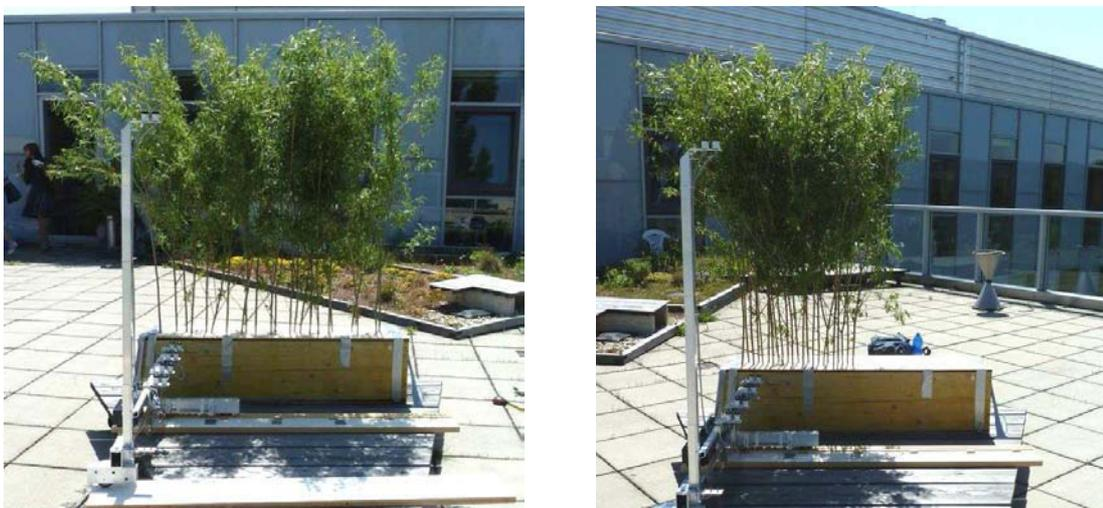
**Abbildung 11** Gleichmäßige Steckweise (Bild links) und flächige Steckweise (Bild rechts) bei 50% Steckdichte am 25.05.2011. Terrasse Schwachhöferhaus 3. Stock / BOKU – Wien.
