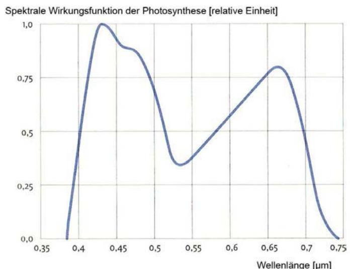
**Abbildung 1** spektrale Wirkungsfunktion der Photosynthese. Beiträge der einzelnen Wellenlängen zur Photosynthese.
