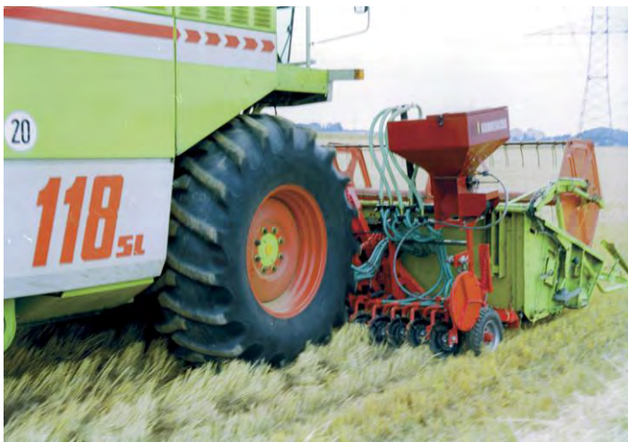
Abbildung 154: Mähdruschsaat, System Güttler, entwickelt 1993 (Quelle: Werkbild Güttler, 2007)
