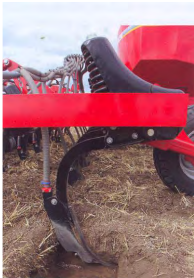
Abbildung 158: Düngerablage Zinken Focus TD (Quelle: HORSCH)
