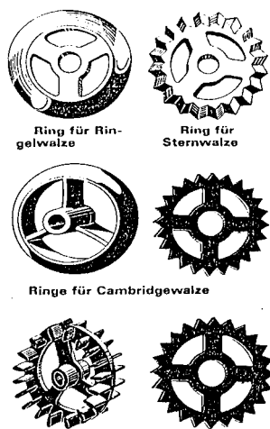
Abbildung 52: Werkzeugelemente der Walzen (Quelle: ATL, März 1996, 216, 6)
