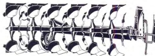
Abbildung 4: 6-Schar Anbau-Volldrehpflug (Quelle:MEINERS et al.,1997,185)
