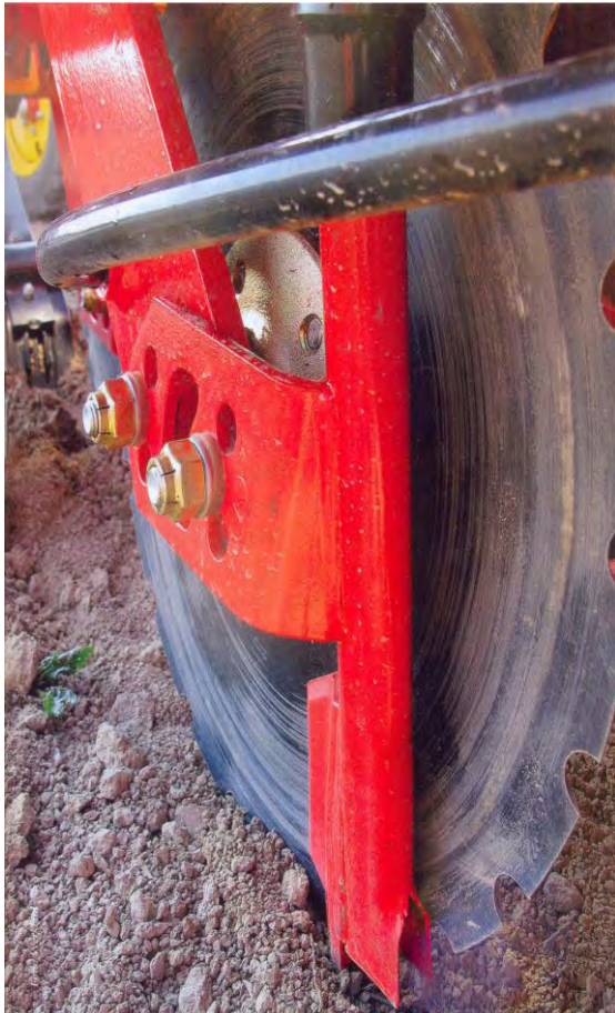
Abbildung 103: Einscheibenschar angewinkelte flache Scheibe mit seitlichem Scharkörper kombiniert. (Quelle: Väderstad „Rapid“)
