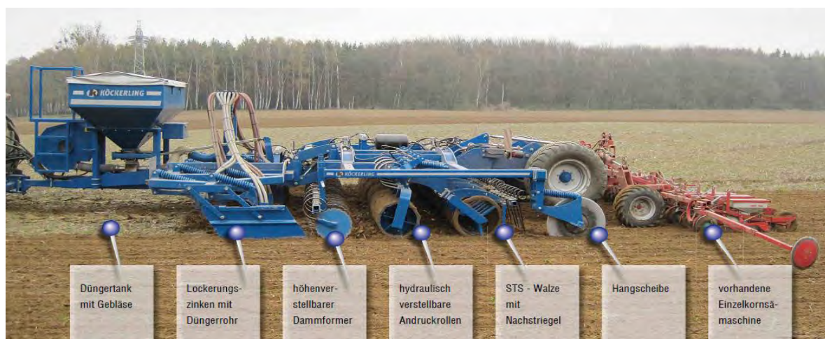
Abbildung 163: Streifenbearbeitung mit Düngerablage und Einzelkornsäat mit konventionellen Säaggregaten (Quelle: Firmenprospekt Köckerling Master)
