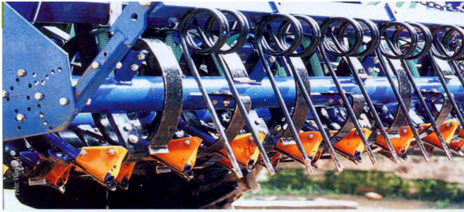
Abbildung 150: Kombination aus Federstempelwalze mit Schleppzinken von Hendlmeier (Quelle: LOP SH, 2011, 20)
