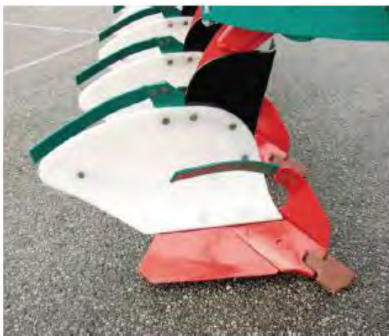
Abbildung 16: Kleiner, stärker zylindrisch geformter Rautenkörper aus Metall oder Kunststoff (Quelle: Firmenprospekt Kverneland)
