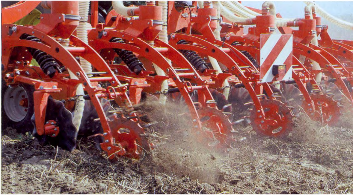
Abbildung 166: Einsatz des Strigers auf einer Fläche mit Zwischenfruchtmulch. (Quelle: LOP 1/2 -2011, 30).
