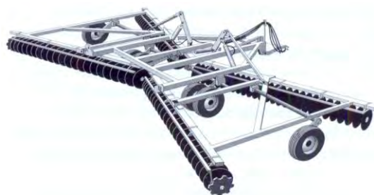
Abbildung 37: Doppelscheibenegge X-Form, 4-reihig, aufgesattelt.
