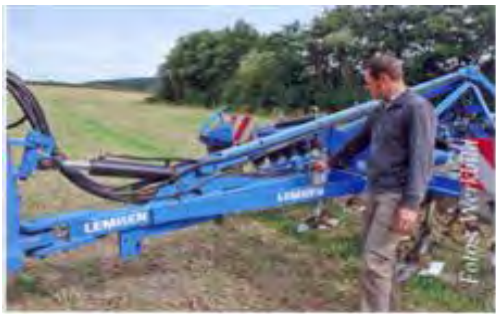
Abbildung 236: Traktionsverstärkung am Grubber (Quelle: LOP, 09/2009,36)
