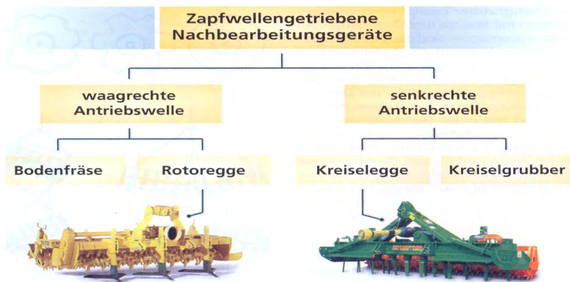
Abbildung 82: Systematik zapfwellenbetriebener Bodenbearbeitungsgeräte (Quelle: ATL 2003, 16)
