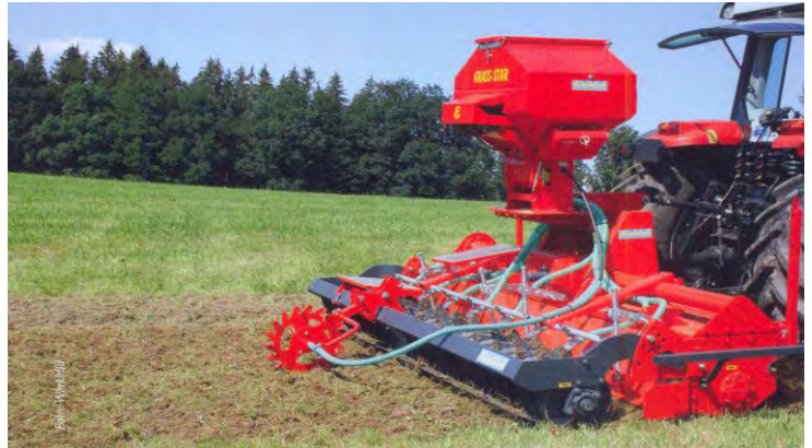
Abbildung 145: Umbruchlose Grünlanderneuerung mittels Frässaat (Quelle: LOP SH 2011, 27)
