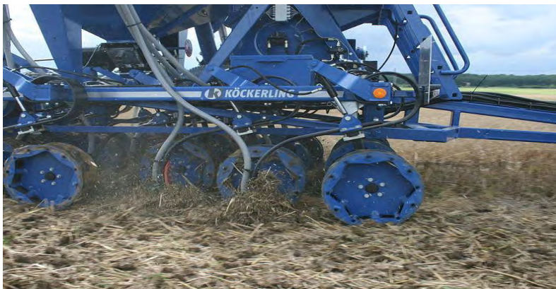
Abbildung 127: Mulchsaat mit der Zinkenschartechnik „Köckerling Ultima 300— (Quelle: LOP SH 2011, 14)
