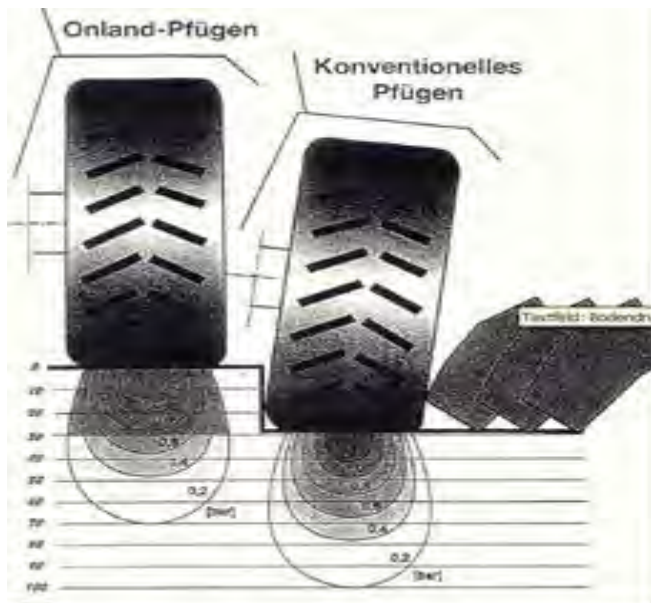
Abbildung 226: Druckverteilung beim On-land-Pflügen und beim konventionellen Pflügen (Quelle: BOKU, Technik Pflanzenbau-Bodenbearbeitung, Folie 29/126)
