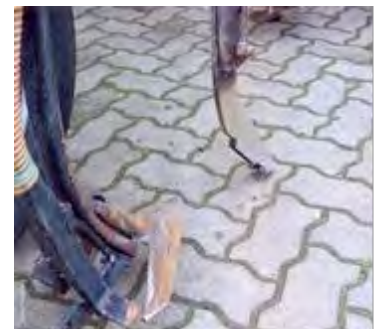
Abbildung 130: Säwerkzeuge: vorne schmaler Lockerungszinken, hinten Gänsefußschar mit Saatgutablage (Quelle: LOP 1 / 2 – 2013, 7)
