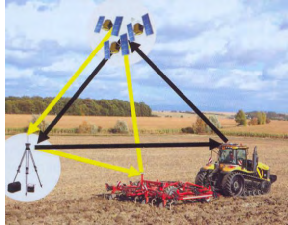
Abbildung 179: Mobile Referenzstation am Feldrand für das RTK-Korrektursignal (Quelle: Terra HORSCH 02/2011, 6ff)
