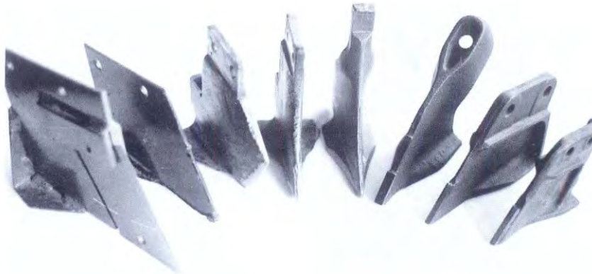
Abbildung 139: Formen des Inverted – T- Schares ( ⊥ ) (Baker Boot-Schar) (Quelle: BAKER, 1996)
