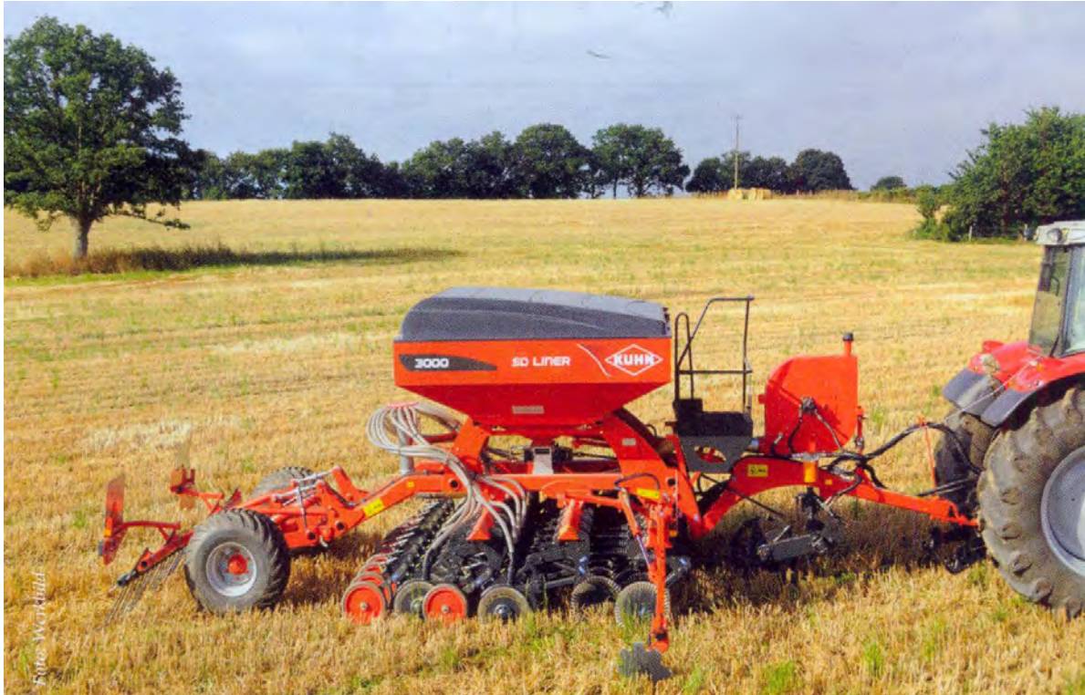
Abbildung 117: Klassische Direktsaat mit der Dreischiebensätechnik (Quelle: vgl.:LOP SH 2011, 6)
