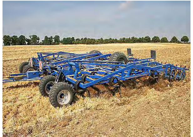
Abbildung 27: 8-balkiger Aufsattelgrubber mit Blattfederzinken, „VARIO—von Köckerling (Quelle: Werkbild Köckerling)
