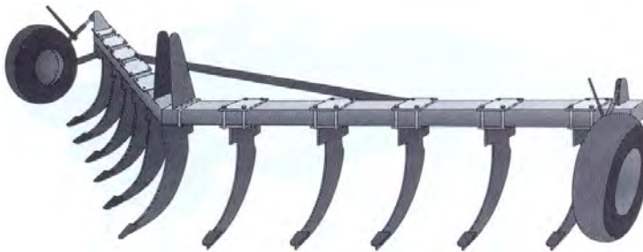
Abbildung 34: Untergrundlockerer mit V-Rahmen (Quelle: Conservation Tillage Systems and Management, 2000, 252)
