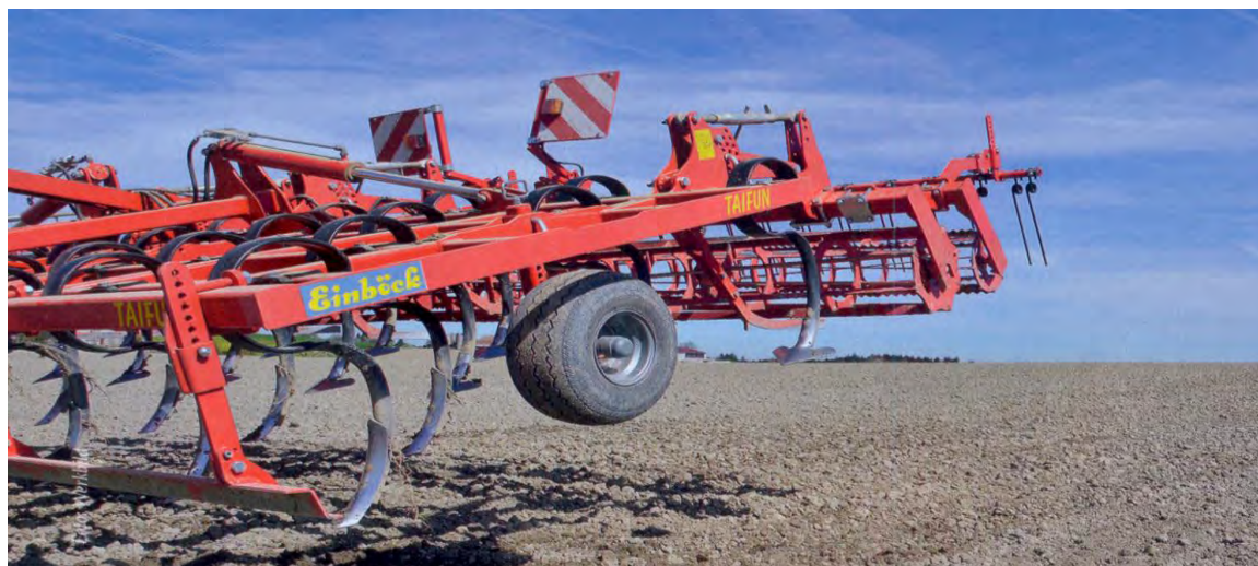
Abbildung 48: Kombination Feingrubber mit Federzinken und Wälzegen, vorne Flachstab, hinten Zahnwälzgege und zweireihigen Nachlaufstriege, Einböck „Taifun.“—(Quelle: LOP 01/02-2014, 6)
