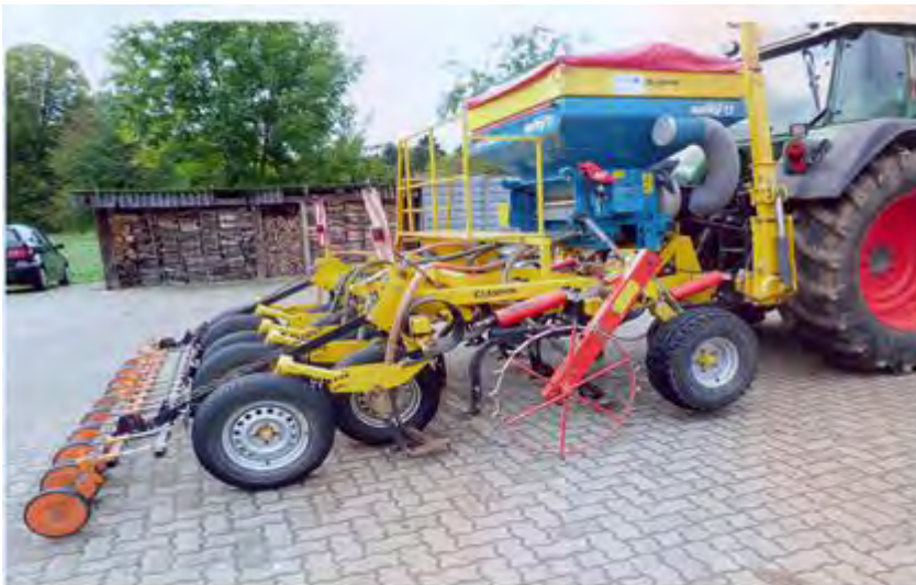
Abbildung 129: Claydon SR-Drill mit dem pneumatischem Säsystem von Sulky (Quelle: LOP 1/ 2 - 2013, 6)
