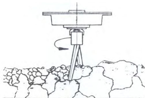
Abbildung 88: Kreiseleggenzinken schleppend (Quelle: ESTLER, 1984, 171)
