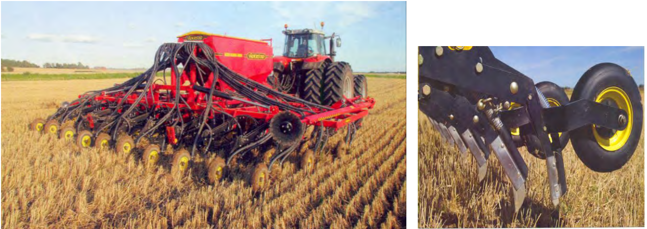
Abbildung 125: Direktsaat mit der Doppelzinkenscharsätechnik Vaederstad „Seed Hawk SH 600— (Quelle: LOP SH 2011, 7)
