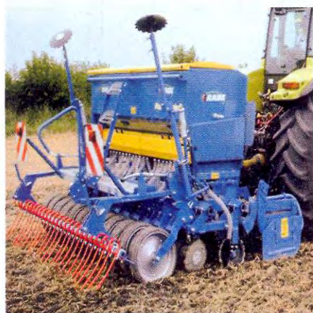
Abbildung 111: Mulchsaatmaschinen mit Einscheiben- bzw. Doppelscheibensätechnik (Quelle: Fortschrittlicher Landwirt 20/2007)
