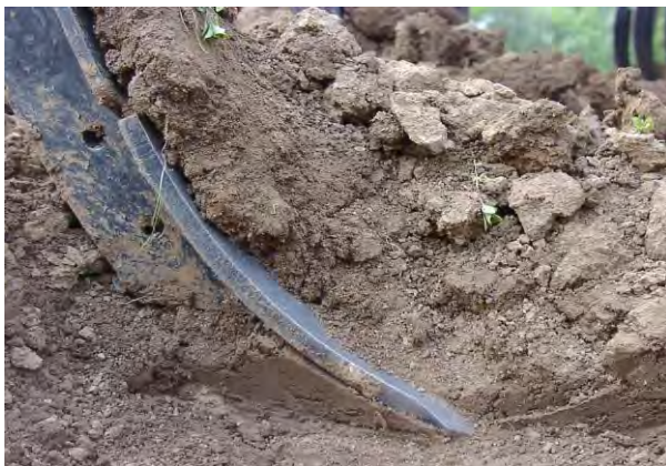
Abbildung 176: MulchMix-Schar, 80 mm breit (Quelle: Horsch- Firmenprospekt 2012)
