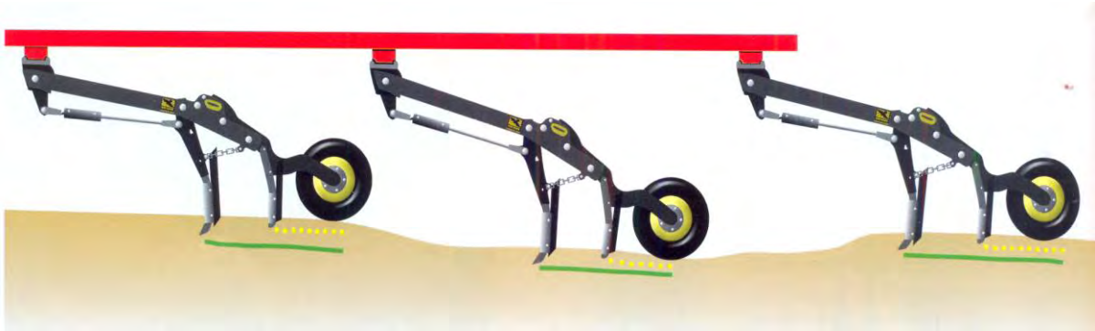
Abbildung 123: Doppelmeißel-Scharsystem (Quelle: Väderstad-Firmenprospekt 2012)
