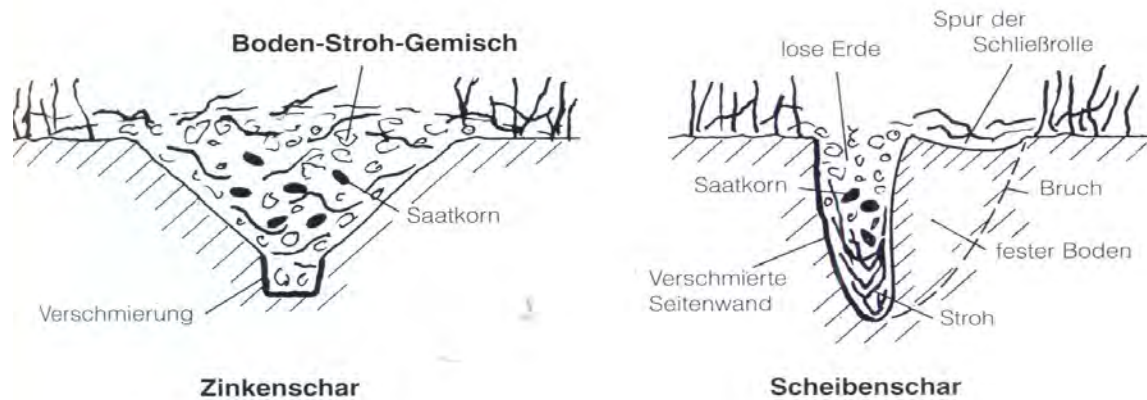
Abbildung 137: Die unterschiedlichen Arbeitseffekte von Scheiben und Zinkensäscharen
