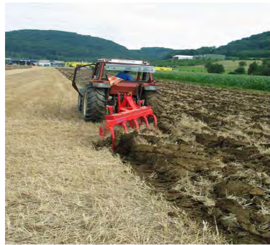
Abbildung 18: 5-schariger Stoppelhobel der Firma Zobel (Quelle: Firmenprospekt Zobl)
