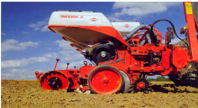
Abbildung 151: Räumsterne an der Einzelkornsämaschine KUHN Maxima 2 (Quelle: LOP SH, 2011, 30)
