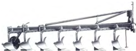
Abbildung 3: Beetpflug, 7-Schare, rechts wendend (Quelle:MEINERS et al., 1997, 185)
