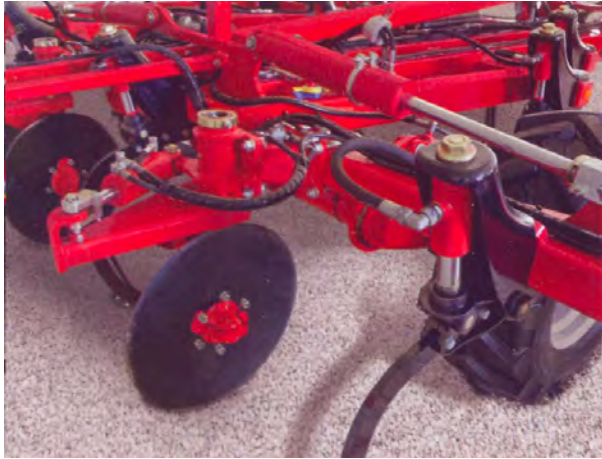
Abbildung 178: GPS gesteuerte Scheibenseche halten den Grubber in der Spur (Quelle: Terra HORSCH 02/2011, 6ff)
