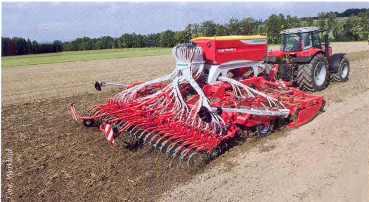
Abbildung 136: Mulchsaat mit Unterfußdüngung mit der Terrasem fertilizer, (Quelle: Pöttinger Firmenprospekt 2012)
