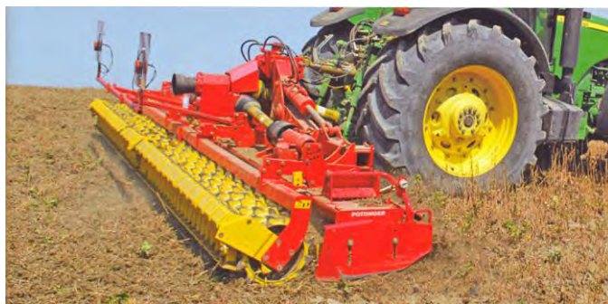
Abbildung 92: Praktischer Einsatz der „LION—als Kreiselgrubber mit Packerwalze beim Einarbeiten der Winter-Zwischenfrucht (Quelle: Werkbild Pöttinger)
