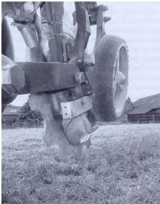
Abbildung 141: Cross–Slot– Schar, horizontal getrennte Ablage von Saatgut und Dünger (Quelle: BAKER, 1996, 55 f)
