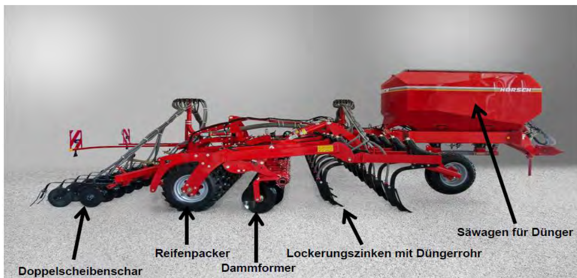
Abbildung 157: Streifenbearbeitung mit Düngung und Aussaat (Quelle: Terra HORSCH 01/2010,6)
