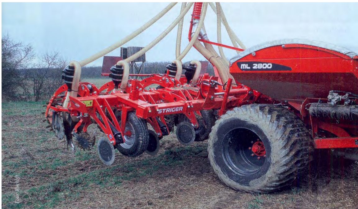
Abbildung 166: Einsatz des Strigers auf einer Fläche mit Zwischenfruchtmulch. (Quelle: LOP 1/2 -2011, 30).
