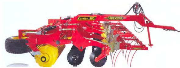
Abbildung 44: Kurzscheibenegge mit Strohstriegel (Quelle: Firmenprospekt Väderstad 2012)
