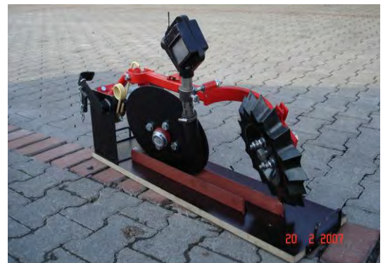
Abbildung 154: Mähdruschsaat, System Güttler, entwickelt 1993 (Quelle: Werkbild Güttler, 2007)
