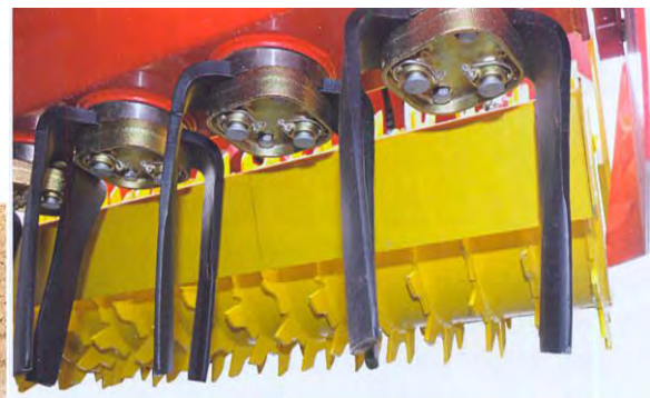
Abbildung 91: Montage Werkzeug los mit Bolzen und Klappstecker (Quelle: Firma Pöttinger)
