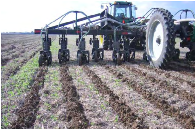
Abbildung 170: Streifenbodenbearbeitung – Strip Tillage in den USA (Bildquelle: Dawn Equipment Company)
