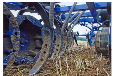
Abbildung 127: Mulchsaat mit der Zinkenschartechnik „Köckerling Ultima 300— (Quelle: LOP SH 2011, 14)
