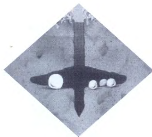
Abbildung 141: Cross–Slot– Schar, horizontal getrennte Ablage von Saatgut und Dünger (Quelle: BAKER, 1996, 55 f)
