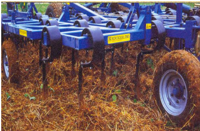
Abbildung 27: 8-balkiger Aufsattelgrubber mit Blattfederzinken, „VARIO—von Köckerling (Quelle: Werkbild Köckerling)
