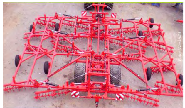
Abbildung 42: Größte Spatenrollegge der Welt, 12 m AB,
