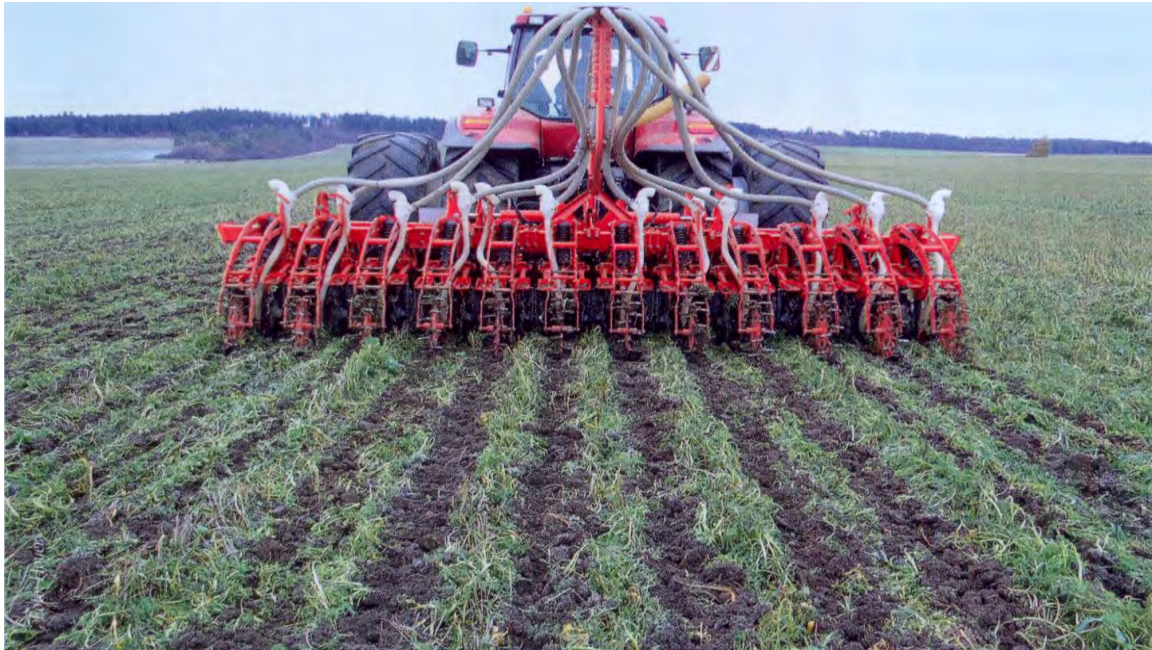
Abbildung 168: Streifenbearbeitung und Zuckerrübensaat in stehender Zwischenfrucht mit dem 12-reihigen Striger (Quelle: LOP, 4/2012, 10)
