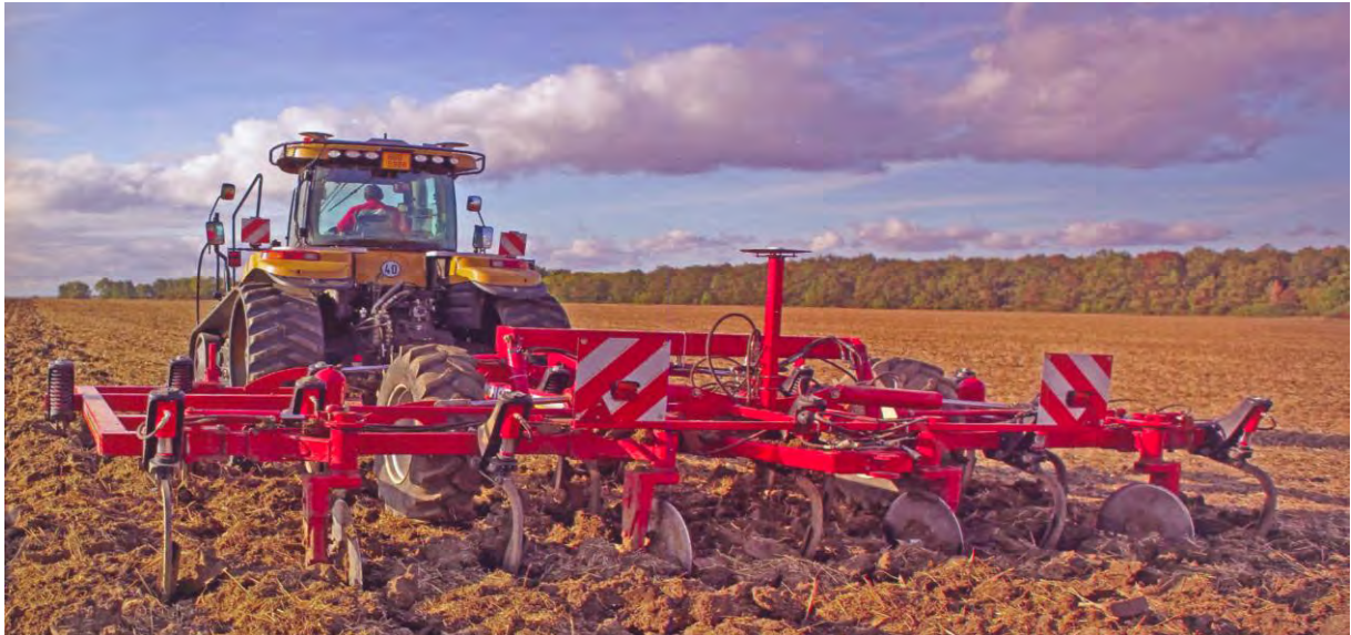
Abbildung 175: Tiger 6 DT im Herbststeinsatz – spurgetreue Führung mittels RTK
