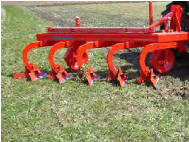
Abbildung 18: 5-schariger Stoppelhobel der Firma Zobel (Quelle: Firmenprospekt Zobl)
