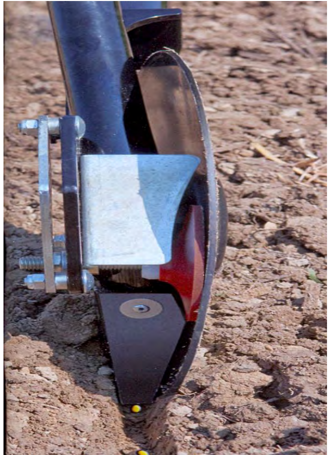
Abbildung 104: Einscheibenschar-angewinkelte Hohl-scheibe (Quelle: Pöttinger-Vitasem 302 A)
