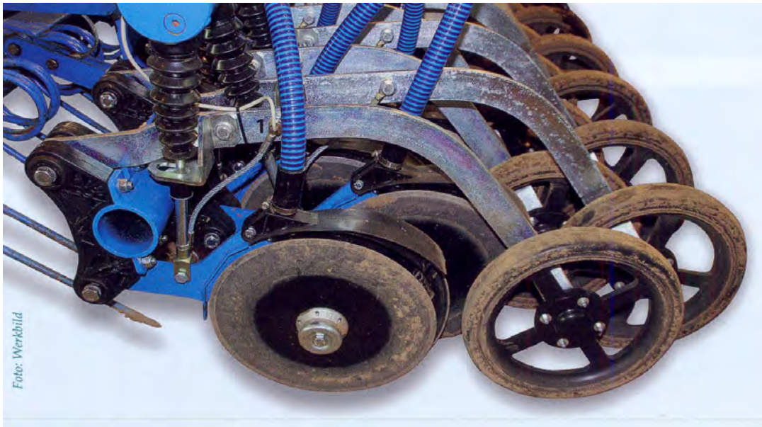
Abbildung 109: Automatische Scharndruckregelung am Doppelscheibenschar Lemken OptiDisc (Quelle: Werkbild Lemken)
