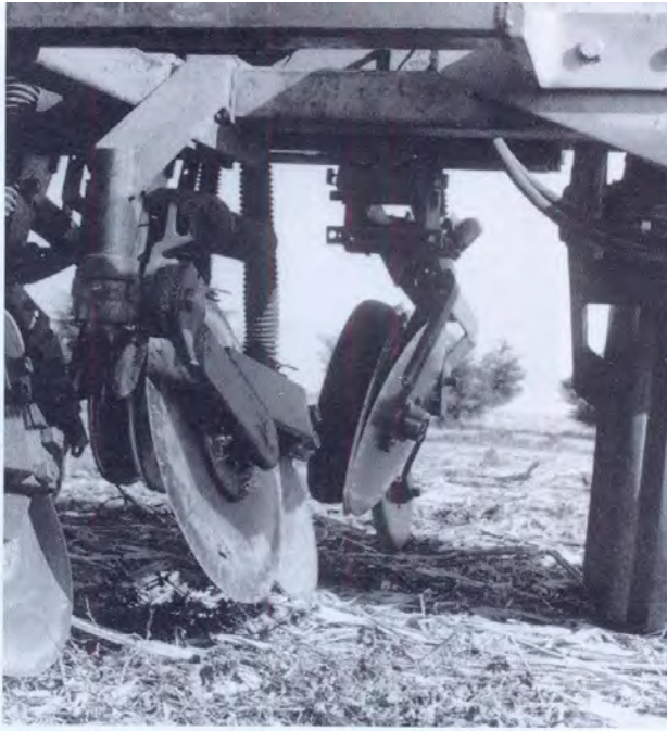
Abbildung 112: Schräg gestellte Doppelscheibenschare (Quelle: BAKER, 1996, 40)
