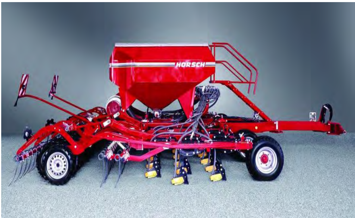
Abbildung 132: HORSCH-Sprinter (Airseeder) mit dem Duett-Schar (Quelle: Werkbild HORSCH)
