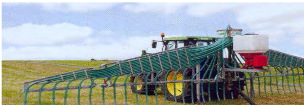
Abbildung 149: Zudosierung mit der pneumatischen Sämaschine von Technik Plus (vgl. LOP SH 9/2011 – 29 f)
