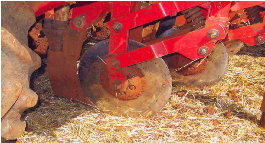
Abbildung 152: Das Guillotine-Schar als Düngerschar an einer Einzelkornsämaschine (Quelle: LOP SH, 2011, 34)
