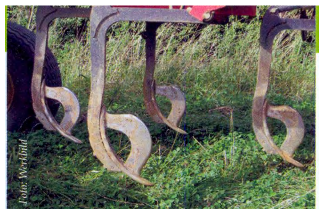
Abbildung 22: „Low Disturbance Schar— (Quelle: Väderstad, LOP 07/2011,8)
