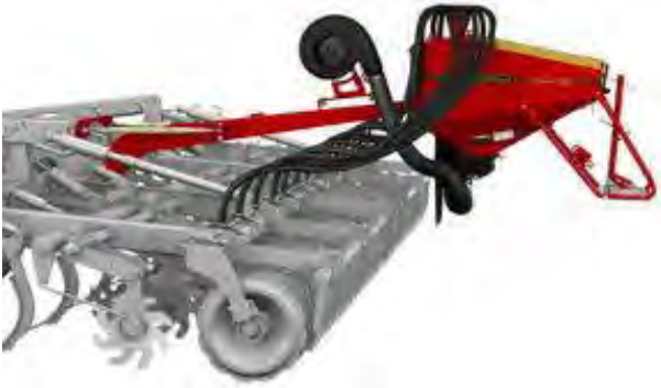
Abbildung 144: Pneumatische Aussaat von Feinsämereien (Quelle: Firmenprospekt Väderstad „Bio-drill–360 (BDA))
