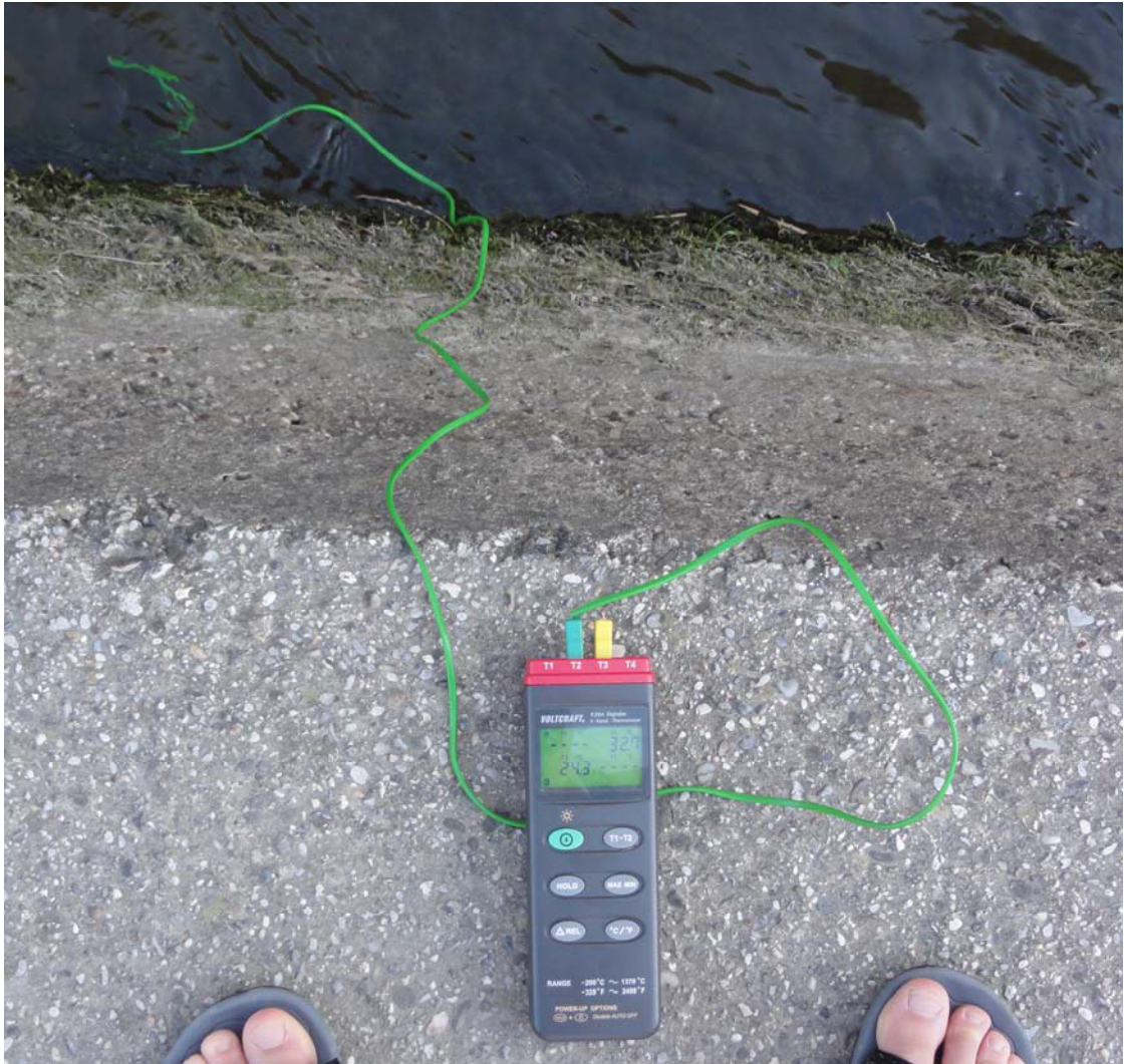
Abbildung 56: Elektronisches 4-Kanal-Thermometer. Wienfluss bei Ober Sankt Veit, 26.8.2011
