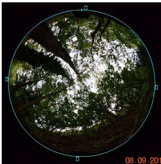
Abbildung 24: Hemisphärisches Foto in Hemi-View geöffnet. Der Bereich für die Analyse (blauer Kreis) wurde dem Bildradius angepasst. Unterpurkersdorf, 8.9.2011.
