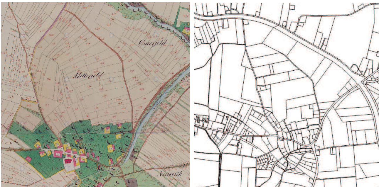
Abb.3 & 4: Vergleich der Flurformen von Mitterkirchen im franzisischen Kataster (ca.1860, links) und im aktuellen Katasterplan (rechts): Nach Kommasierungsmaßnahmen ist die ehemalige blockartige Streifenflur kaum noch zu erkennen. (Quelle: doris.gv.at)
