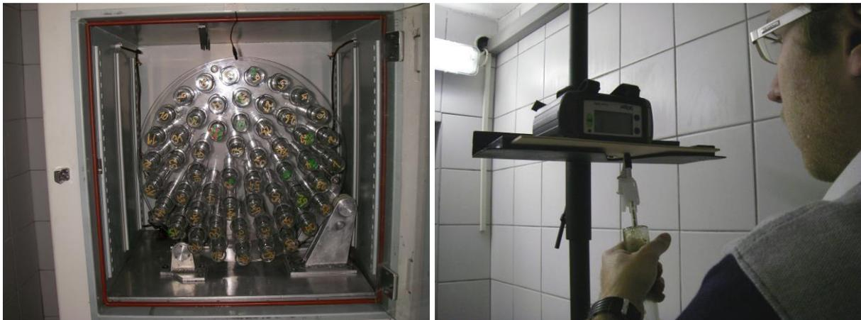
**Abbildung 11: Hohenheimer Biogasertragstest: Kolbenprober in drehbarer Trommel (links), Gasanalyse (rechts)**
