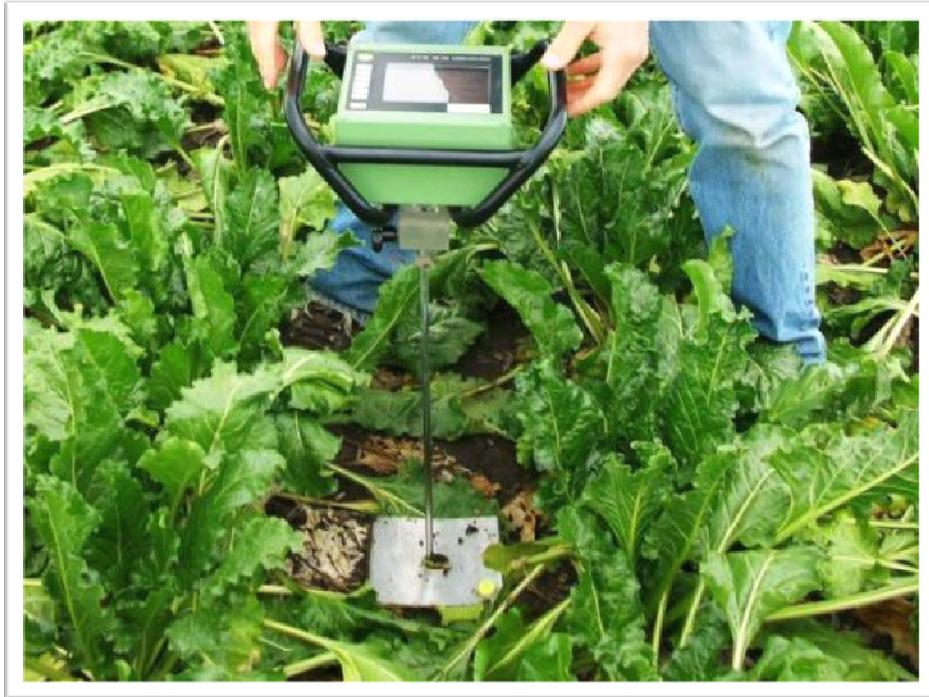
Abbildung 10: Eindringwiderstandsmessung mittels Penetrologger bei ZR, Groß Enzersdorf 2011 (Refenner 2011)
