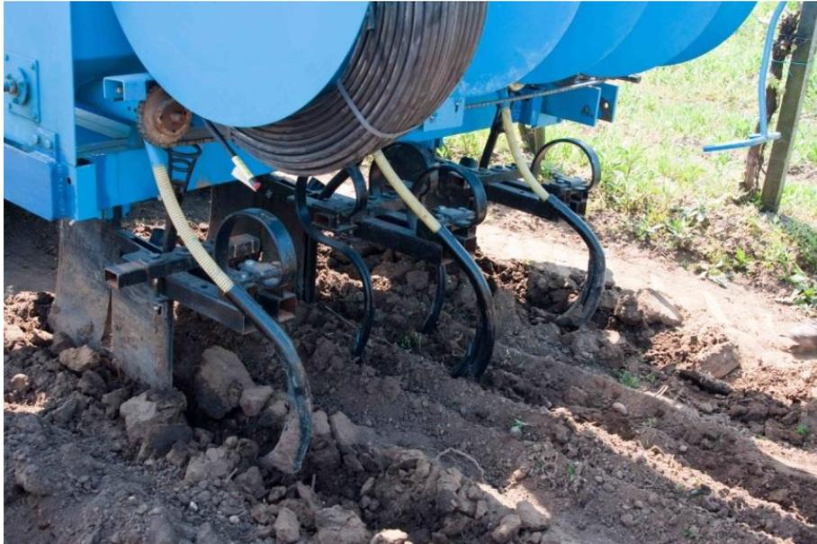
Abbildung 1-3: Einbau der Unterflurbewässerung und Zugabe des Betasoil in einem Arbeitsgang
