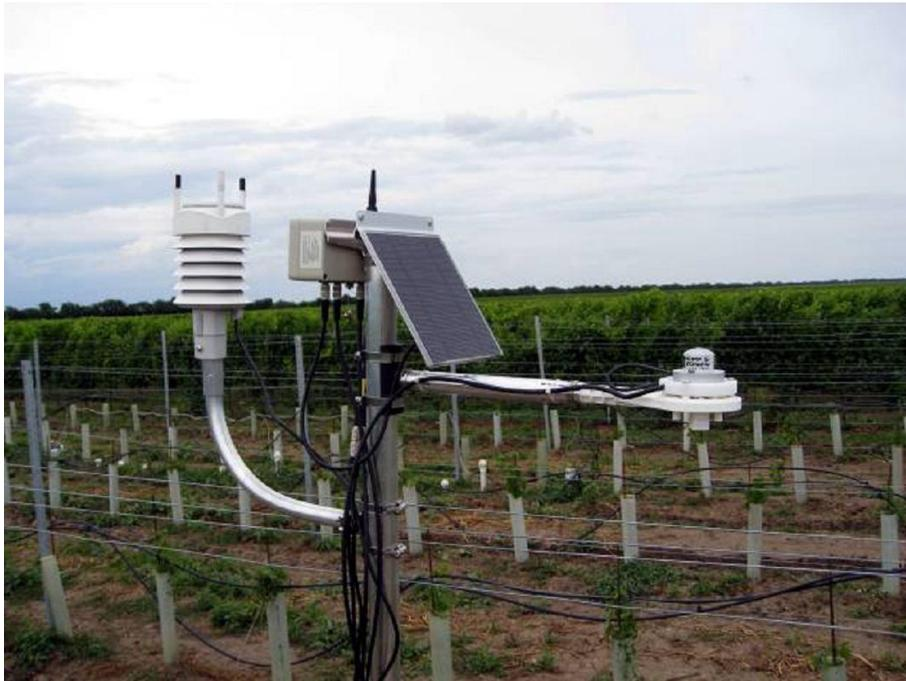
Abbildung 4-1: Messstation auf der Versuchsfläche in Andau mit Solarpanel und RTU<sup>14</sup>
