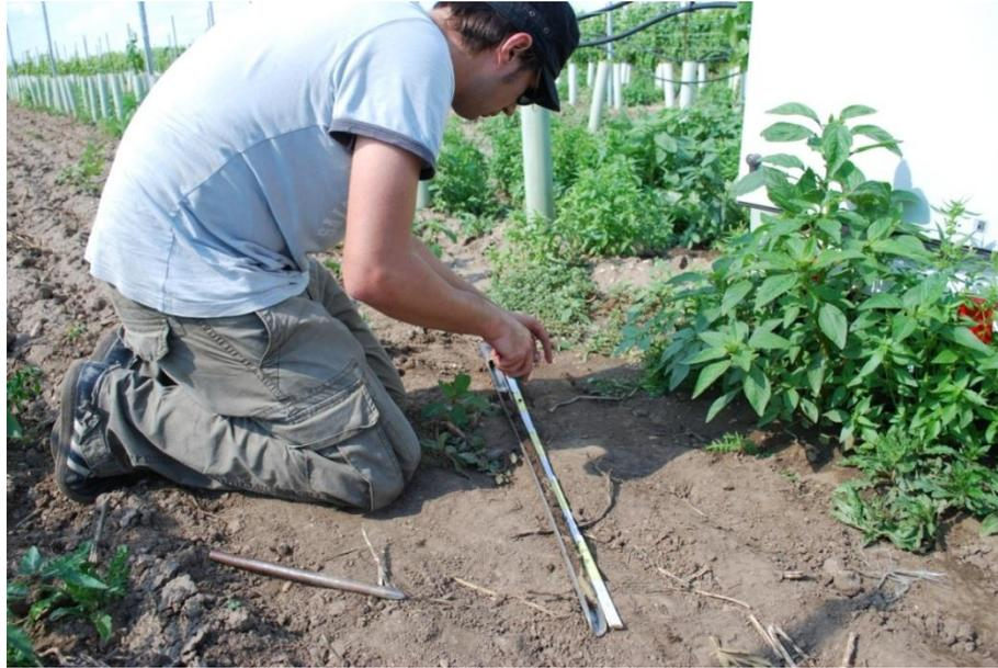
Abbildung 3-7: Einteilung der Profiltiefen am Bohrstock
