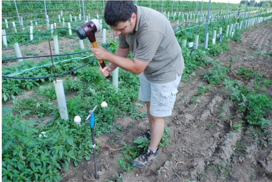
Abbildung 3-6: Einschlagen eines Bohrstockes
