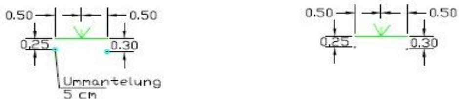
Abbildung 1-2: Profile der Versuchsfläche mit den Einbautiefen des Bewässerungsschlauches (links mit Betasoil und rechts ohne)
