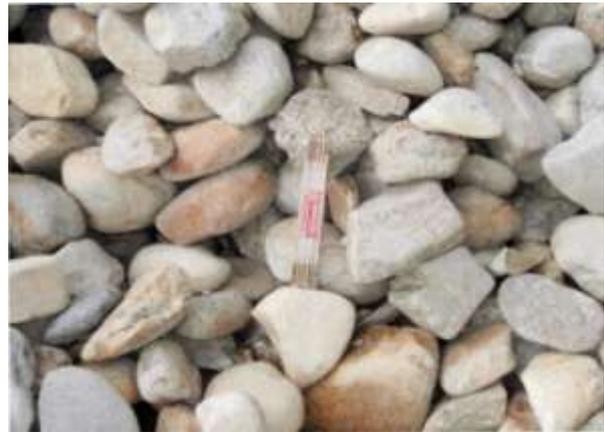
Abbildung 32: Rundkorn - 100/250 in Seebarn bei Krems (Quelle: PRESSLER 2006)
