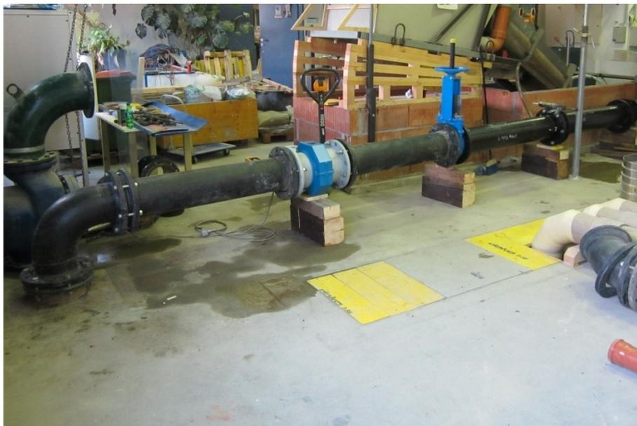
**Abbildung 33: Versuchsstrecke vom Anschluss an die Ringleitung bis Rohr 5**
