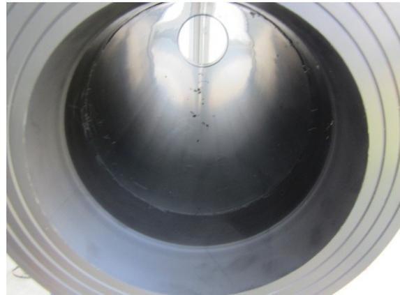
**Abbildung 38: Einsicht ins Rohr ohne Schweißfalz**
