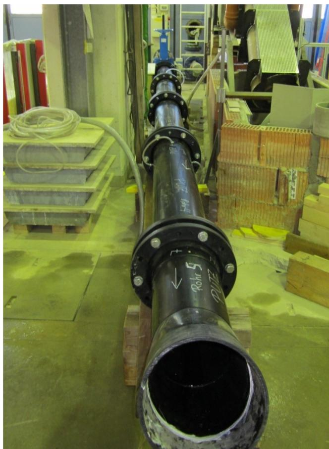
**Abbildung 34: Versuchsstrecke vom Plattenschieber bis Rohr 8 (30° Bogen), Versuchsstreckenende**
