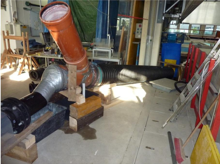
**Abbildung 35: Wasserableitung ab Rohr 8 bis Rigol (Versuchsnr. 0.1.1, 0.2.1, 1.1, 1.2)**
