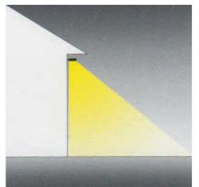
Abb. 118: Korrekte Lichtlenkung, das Licht wird nur in Richtung Boden gestrahlt
