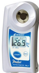
Abb. 28: Digitaler Handrefraktometer (ANONYM, 2011e)
