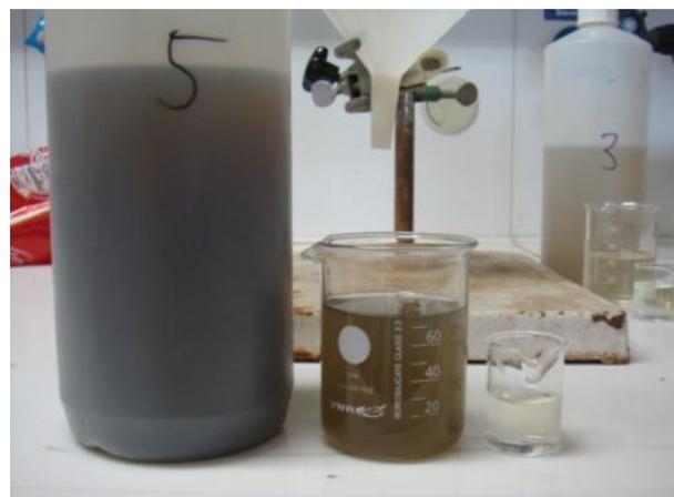
Abbildung 4-17: Probe unfiltriert (links), mit Faltenfilter (Mitte) und mit Spitzenvorsatzfilter (rechts)
