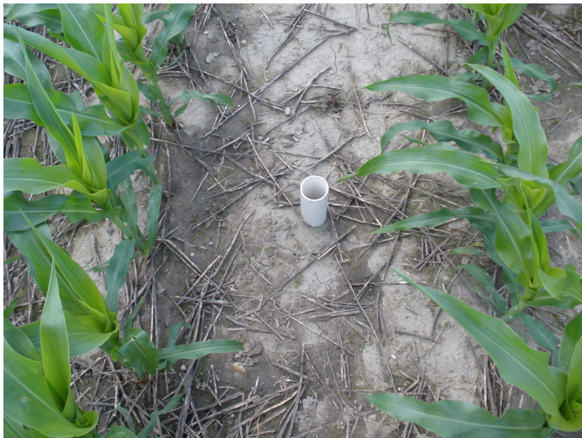
Abbildung 16: Beprobungsrohr für die Bodenwassermessungen
