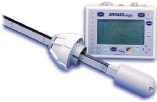
Abbildung 15: Diviner Sentek zur Messung des Bodenwassergehalts
