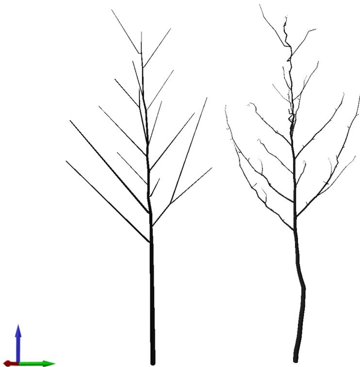
Abbildung 38: Vergleich von Aufnahmen mit unterschiedlichem Genauigkeitsgrad; links: grobe Aufnahme mit 47 Messpunkten; rechts: Aufnahme mit 350 Messpunkten
