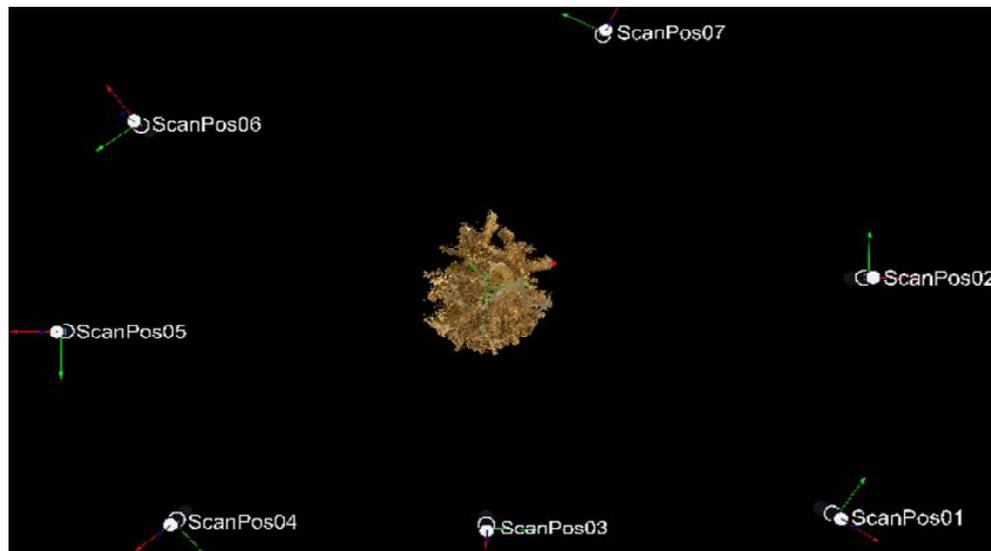
Abbildung 12: Lageplan von 7 Aufstellungen mit 7 verschiedenen Koordinatensystemen um das Messobjekt (PFLEGERL, M., 2008, S.44).
