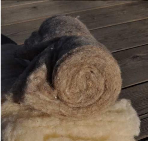
Abbildung 7: Dämmplatten aus Schafwolle
