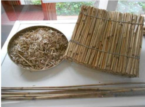
Abbildung 8: Schilfhäcksel und Schilfrohrmatte
