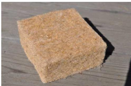
Abbildung 2: Dämmmatte aus Hanffasern
