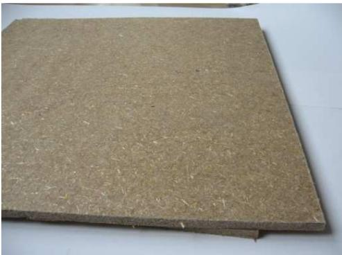
Abbildung 5: Holzfaserdämmplatte
