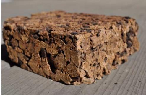
Abbildung 4: Korkdämmplatte
