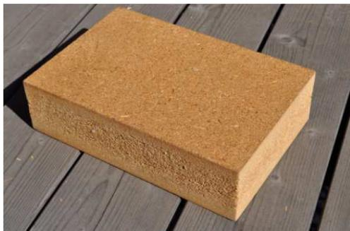
Abbildung 6: Holzfaserdämmplatte
