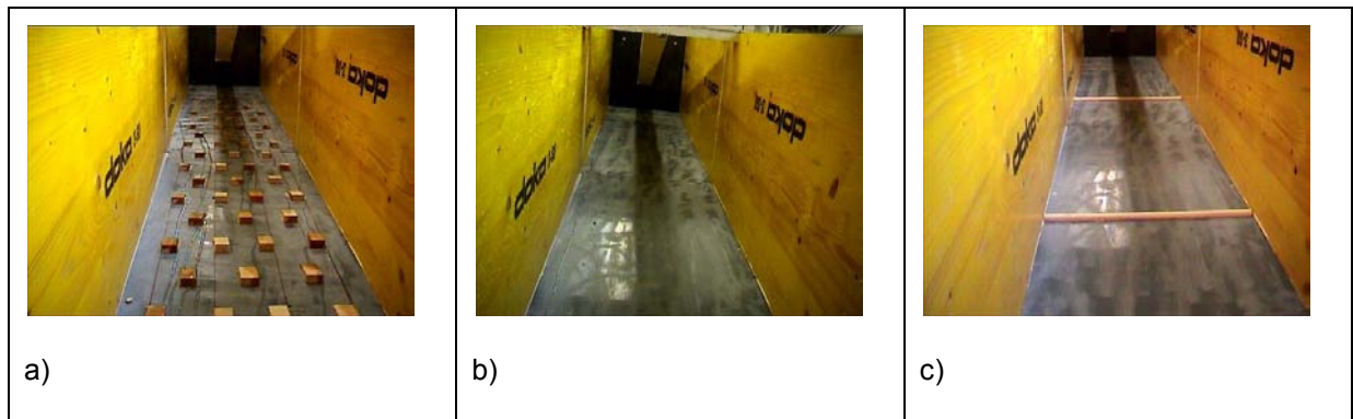
Abbildung 31: verschiedene Bodenrauhigkeit a) Bodenplatte mit Hartholzkeilen b) Bodenplatte PVC angeschliffen c) Bodenplatte PVC angeschliffen und drei Halbrundhölzer über die gesamte Breite.
