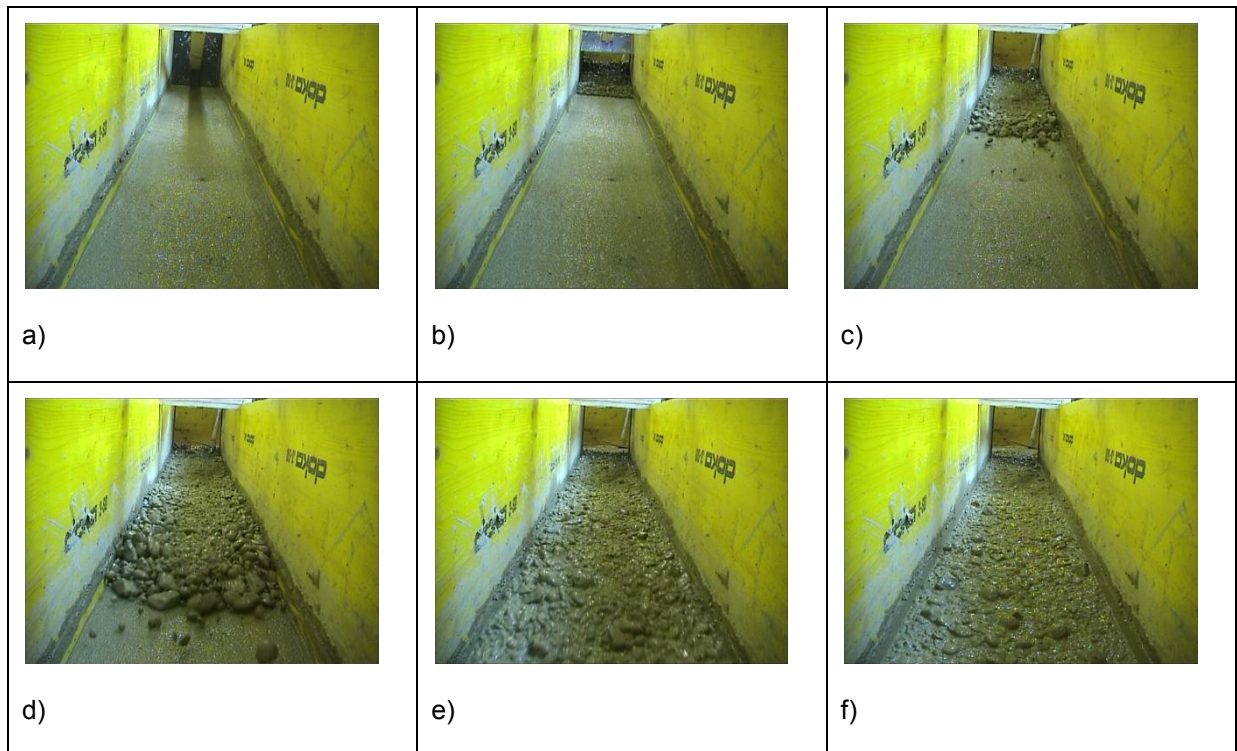
Abbildung 39: Versuch G13 Rinne a) bis f) chronologische Abfolge des Versuchs G13.
