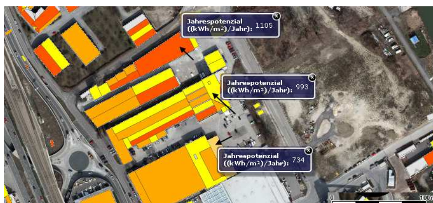
Abbildung 32 Solarkatasterpotentialkarte Ausschnitt Firmengelände Electrovac Schüttau (Schmuckenschlager 2011)
