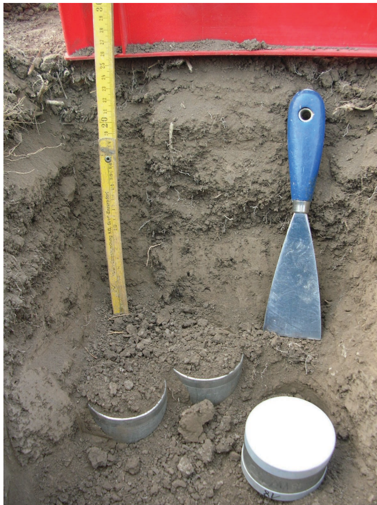
Abb. 21: Der Zylinder wird mit dem Deckel auf der Unterseite verschlossen (Foto: STREBL, 2006)
