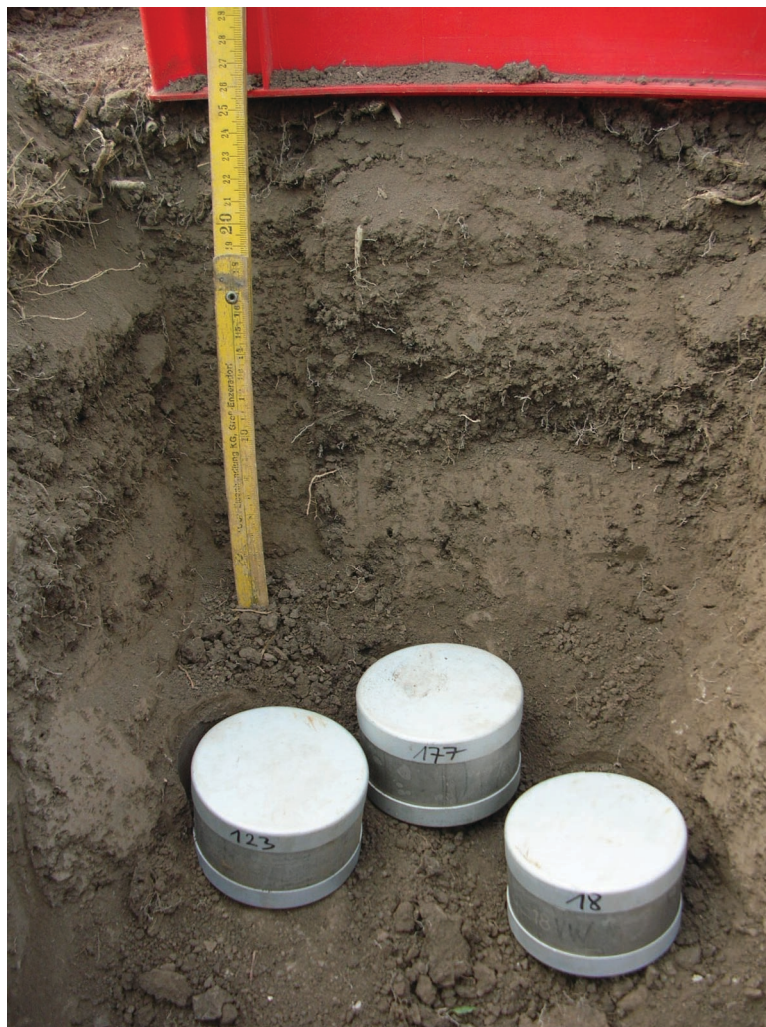
Abb. 22: Alle 3 Zylinder sind an der Ober- und Unterseite verschlossen (Foto: STREBL, 2006)
