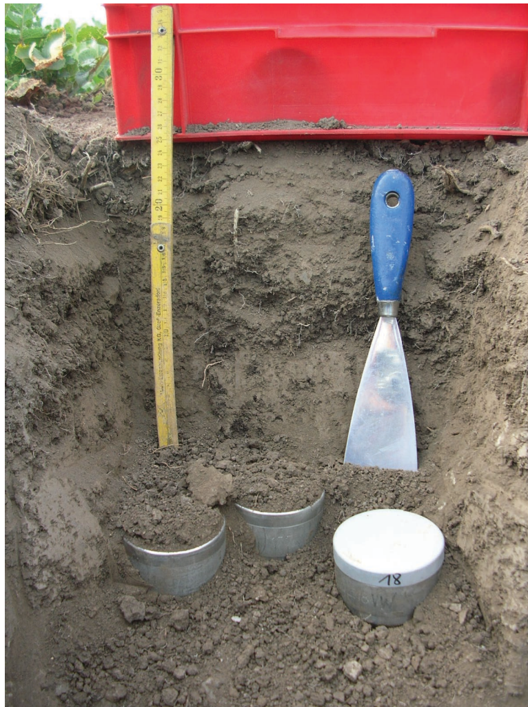
Abb. 20: Der Zylinder wird an der Oberseite mit dem dazu passenden Deckel geschlossen (Foto: STREBL, 2006)
