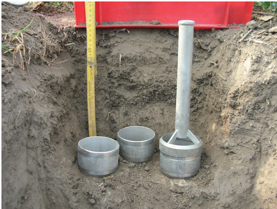
Abb. 17: Schlagstock mit Stützring auf einem Zylinder angesetzt (Foto: STREBL, 2006)
