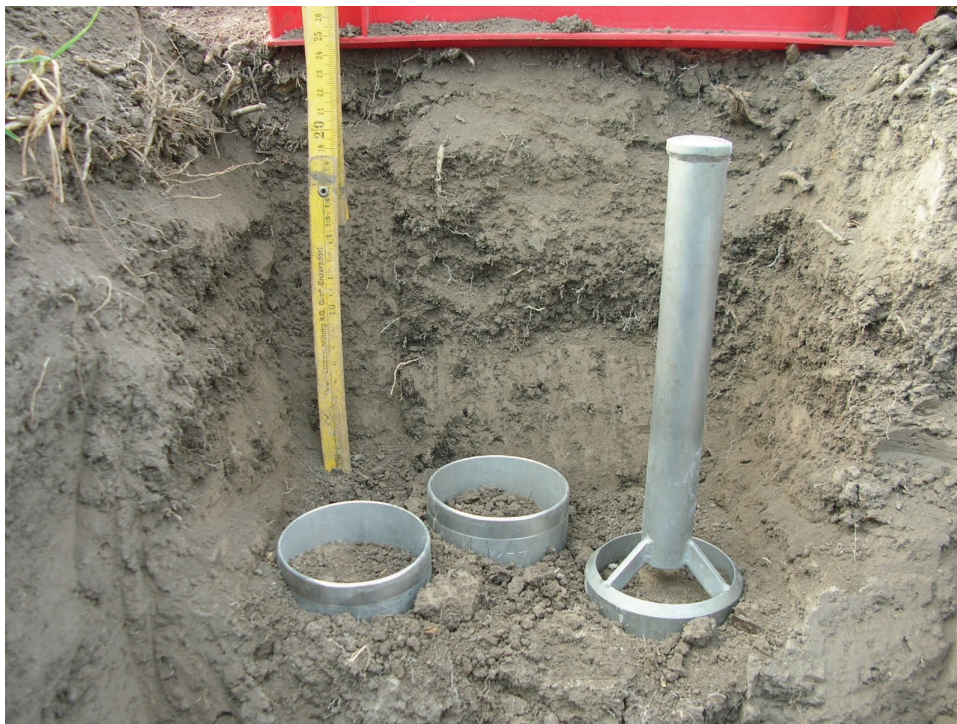
Abb. 18: Zur Hälfte in den Boden geschlagene Zylinder auf vorgegebener Tiefe (Foto: STREBL, 2006)
