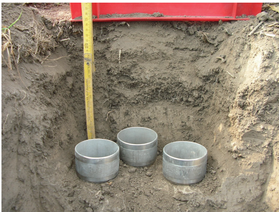
Abb. 16: Stechzylinder in der vorgegebenen Bodentiefe von 25 cm (Foto: STREBL, 2006)
