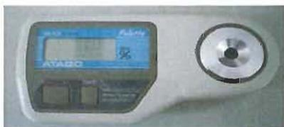
Abb. 6: Refraktrometer
